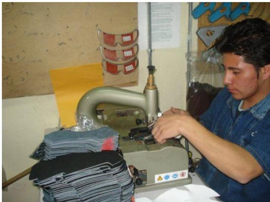
**Fotografía 6.** Modelado. Se reduce el grosor del cuero con una máquina.
