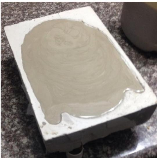
*Figura 25-Colocación de barbotina en molde de yeso*
