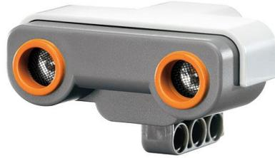
Figura 1.6. Sensor Ultrasonico
