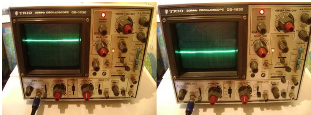
Figura 4.6 Señales positivas y negativas de cinco voltios.
