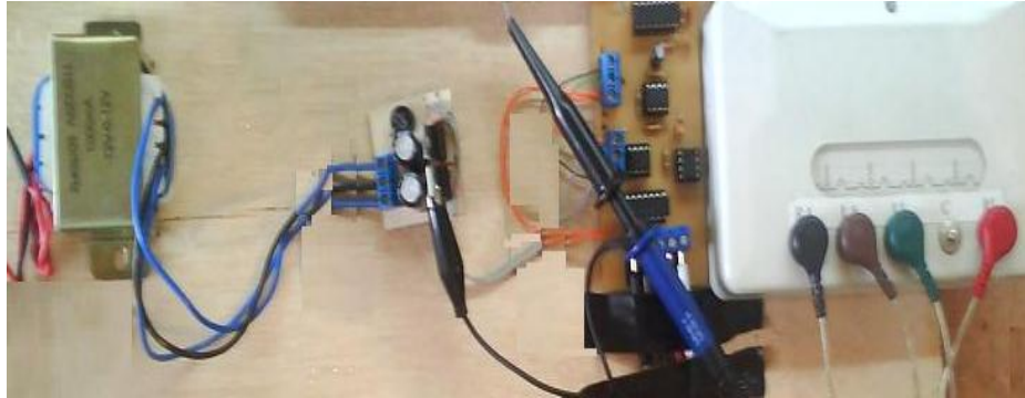
Figura 4.2 Generador de señales usado en el desarrollo del proyecto.
