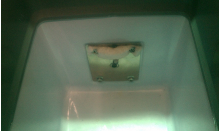
Figura 49 Posición del Sensor de Temperatura en el Contenedor
