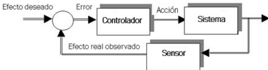
Figura 1 Ejemplo de un Sistema de Control
