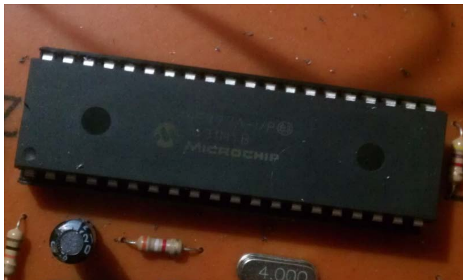
Figura 39 PIC 16F877 en Placa
