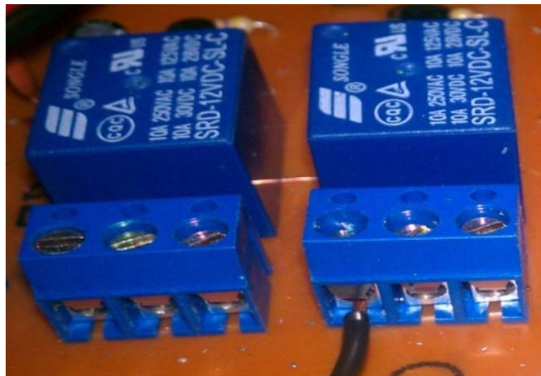
Figura 34 Relés en la Placa
