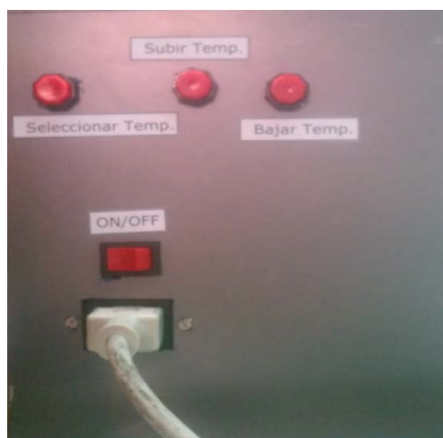
Figura 46 Pulsadores, Interruptores y Conectores
