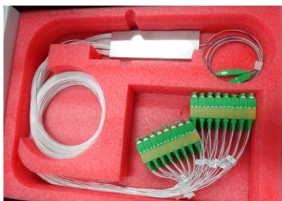
Figura 2.35 Splitter Óptico de 2 entradas - 32 salidas
