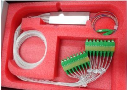
**Figura 2.35 Splitter Óptico de 2 entradas - 32 salidas.**
