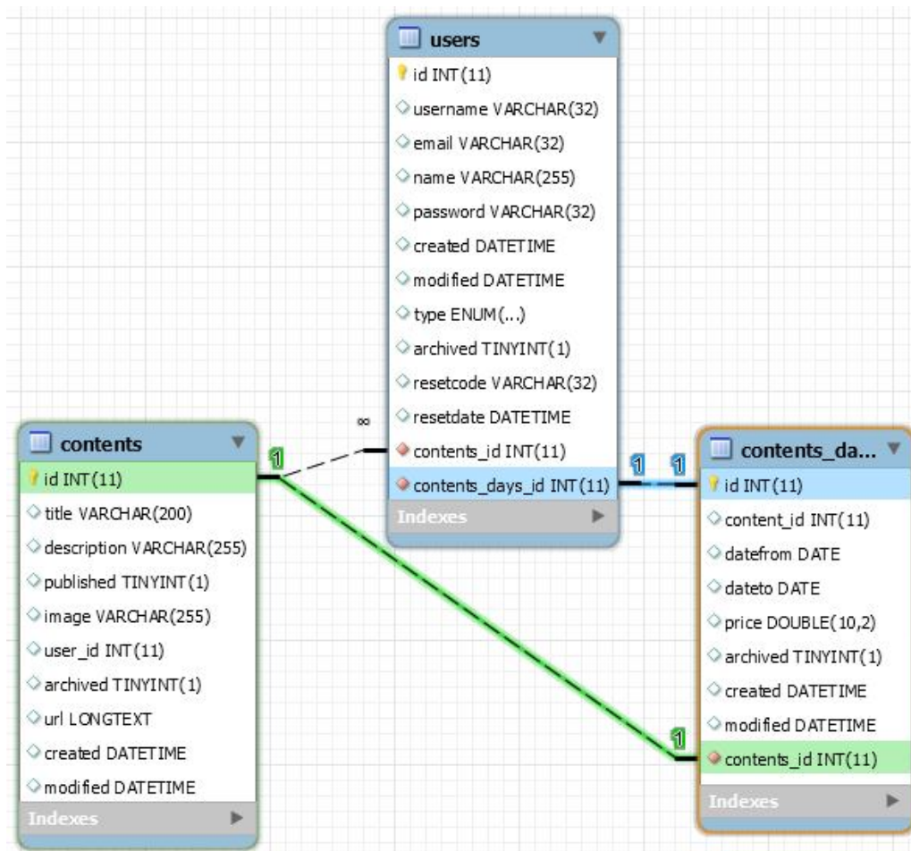
Figura 19: Vista lógica de la Base de datos
