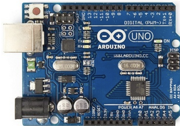
Figura 9. Placa Arduino en formato SMD. Fuente: (RCO ELECTRÓNICA, 2014)
