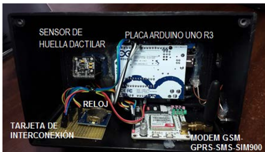
Figura 30. Conexión interna final
