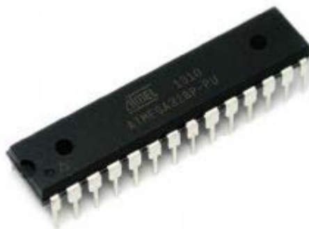
Fotografía 10. Microcontrolador ATmega 328P Fuente:(xt:Commerce VEYTON , 2009)
