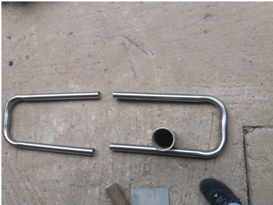
Figura: Doblado de los tubos
