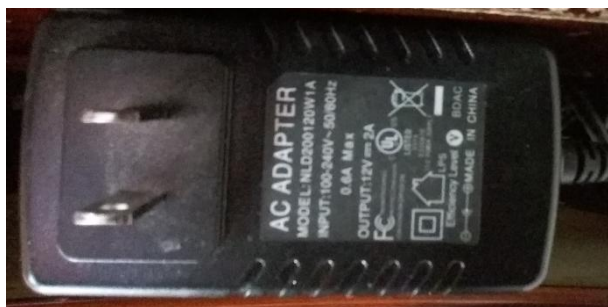
Figura: Adaptador 110 AC-12 DC
