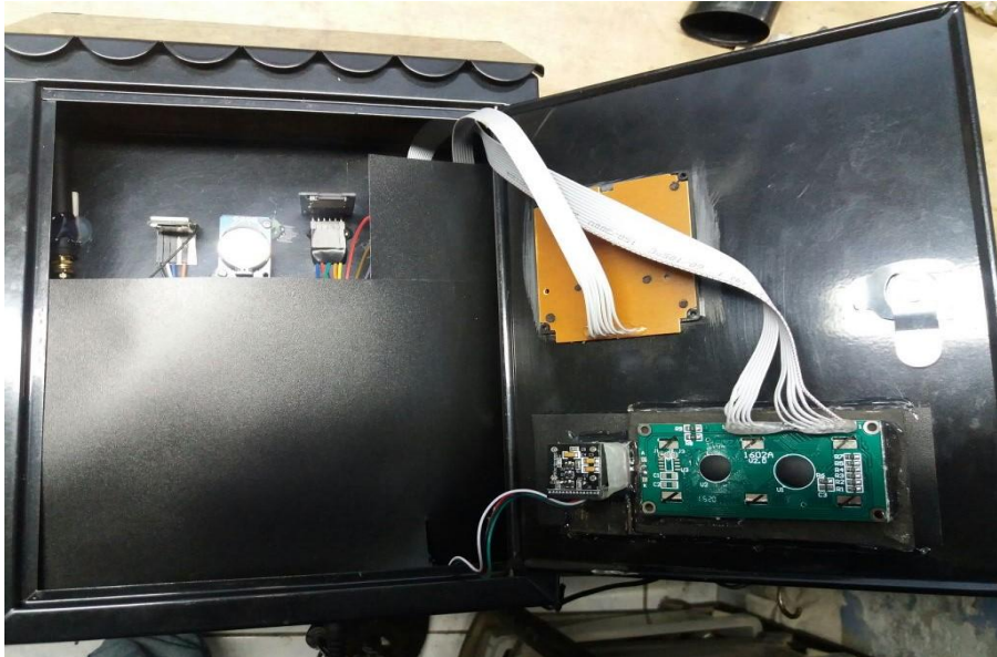
Figura 29: Colocación de placa para hermeticidad
