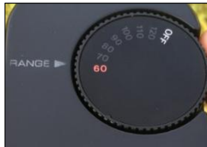
Figura 3.4 Rangos de sonido (dB) del sonómetro.
