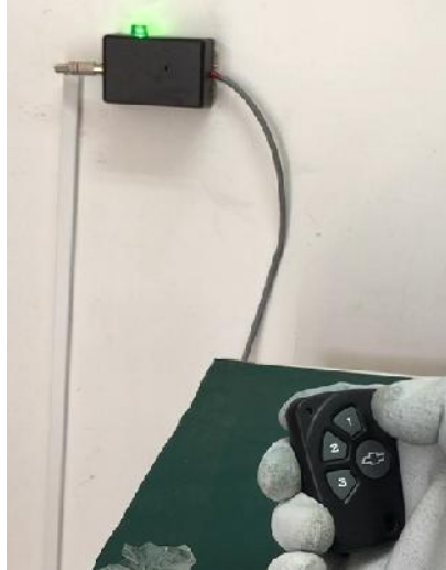
Figura 3.45 Actuador visual en la estación de controles remotos
