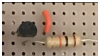
Figura 3.22 Pruebas en placa genérica con transistor 2N3904.
