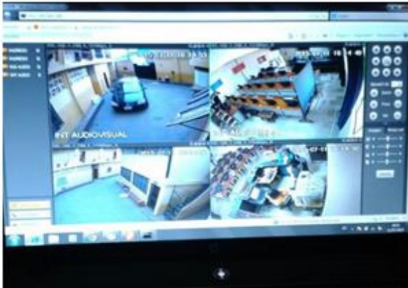
Figura 30. DVR ViperTeK que se utilizó en el sistema CCTV de la escuela y su modo de visualización.
