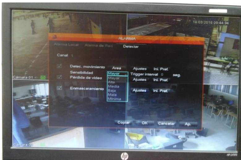
Figura 63. Detección de movimiento en sensibilidad ajustada a nivel de “mayor”.
