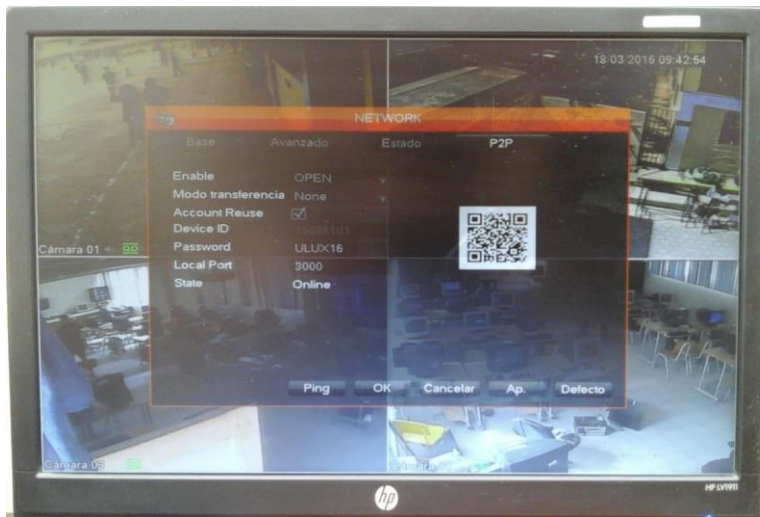
Figura 58. Configuración P2P en el DVR.
