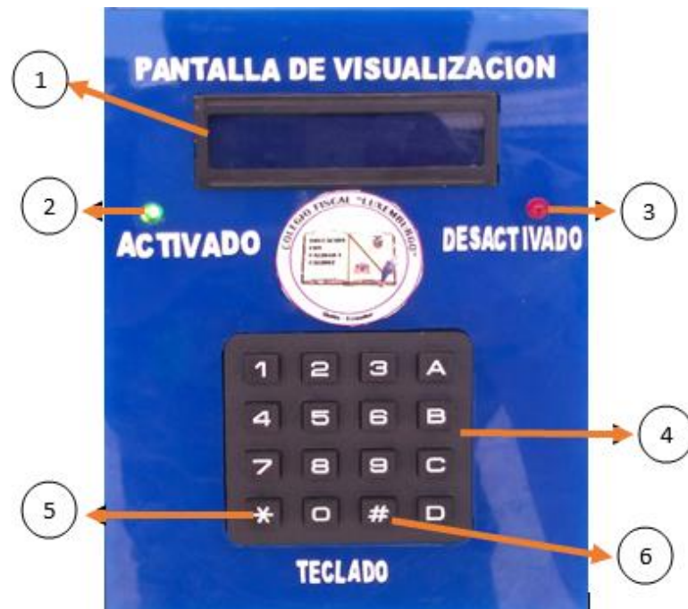
Figura 1. Partes y accesorios del tablero para el control de acceso.
