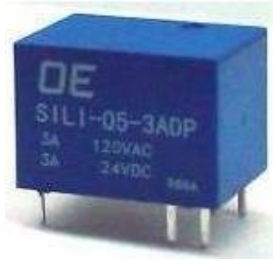
Figura 24. Relé de 5V con sus respectivas especificaciones del fabricante.
