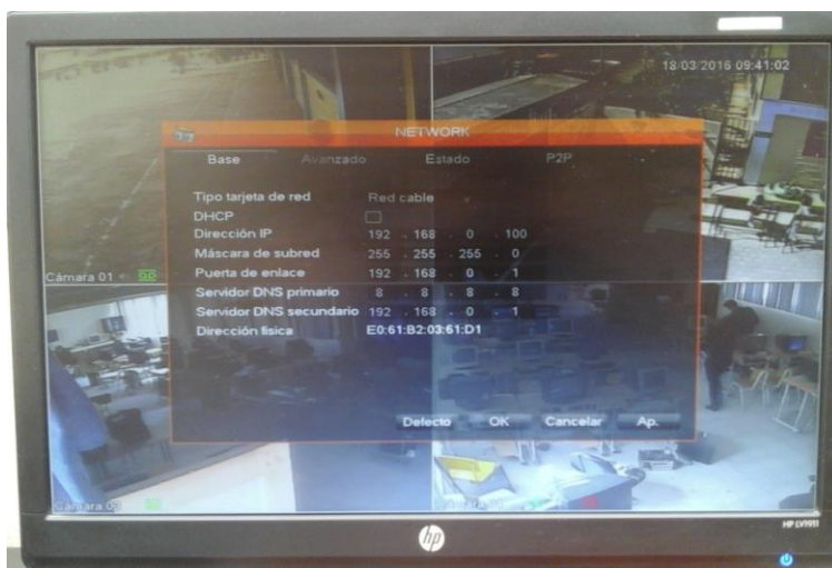
Figura 59. Configuración en el DVR para el acceso al internet.
