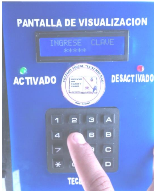
Figura 68. Mensaje que indica el inicio de la digitación de clave.
