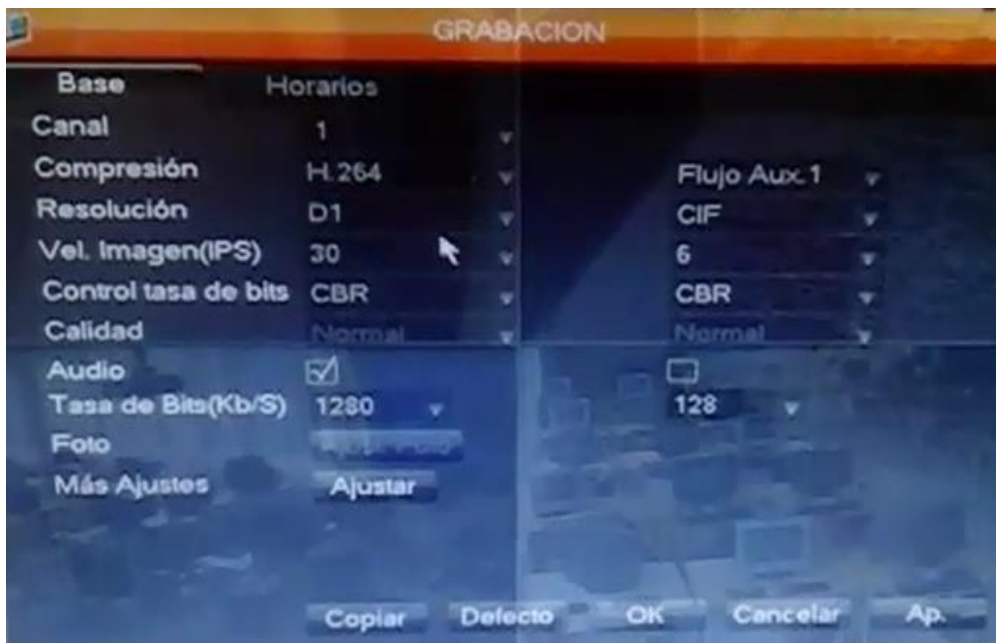
Figura 65. Configuración de la calidad del video en cada canal.
