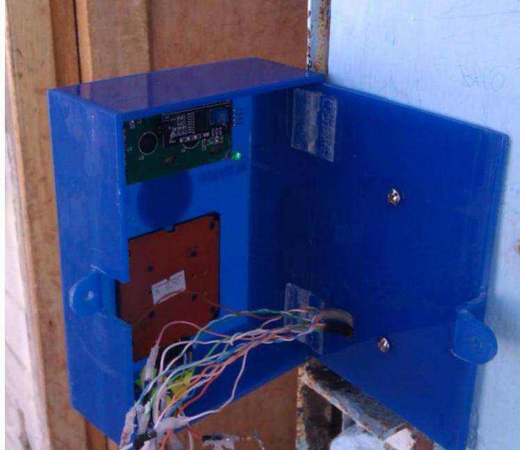
Armado de la caja de validación de contraseña que incluye la LCD, teclado, LED's y buzzer.
