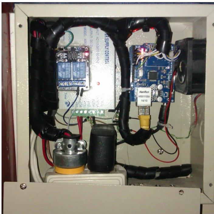
Figura 57. Tablero de control de la puerta de acceso implementada en el interior del laboratorio.
