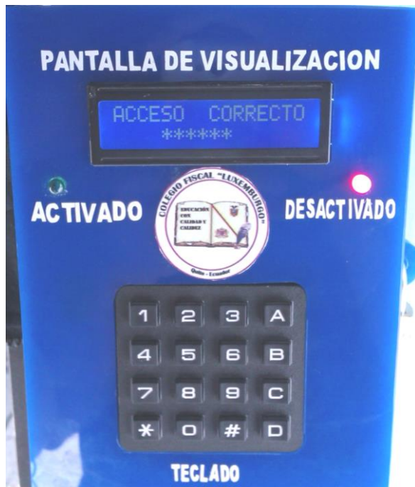
Figura 69. Mensaje que se presenta rápidamente de la digitación correcta de la contraseña.
