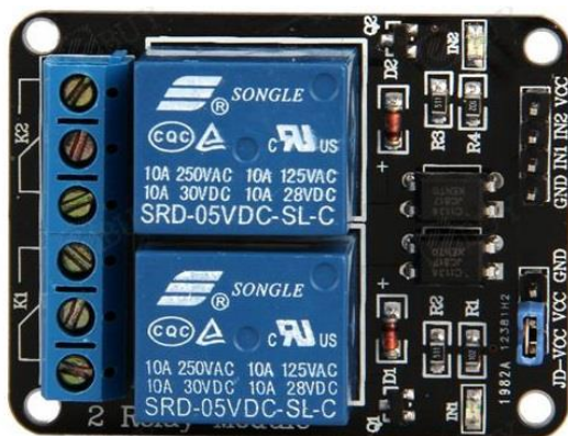
Figura 52. Módulo Relé Arduino de 2 entradas.
