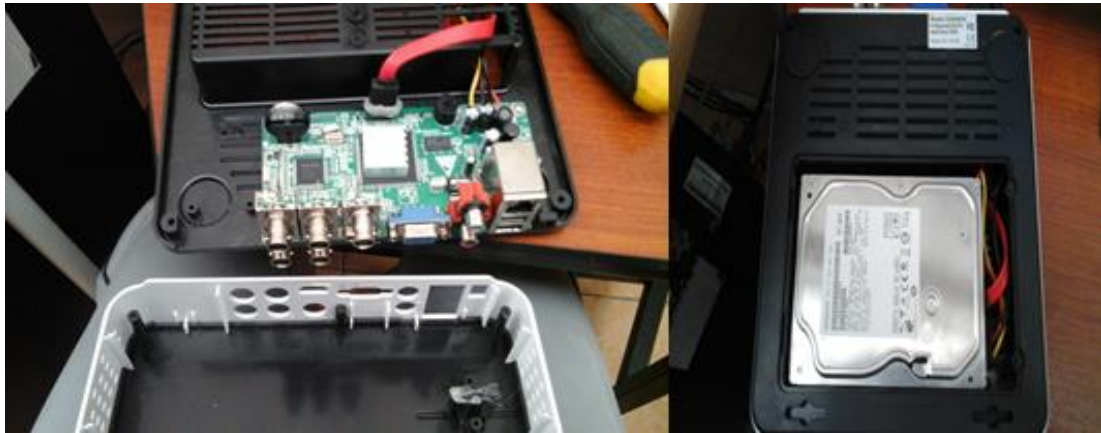
Figura 47. Instalación del Disco Duro en el interior del DVR.
