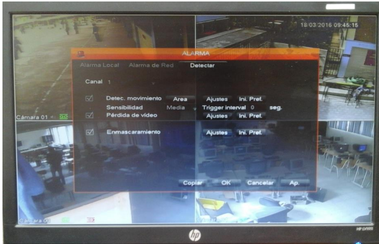
Figura 64. Detección de movimiento en sensibilidad ajustada a nivel “media”.
