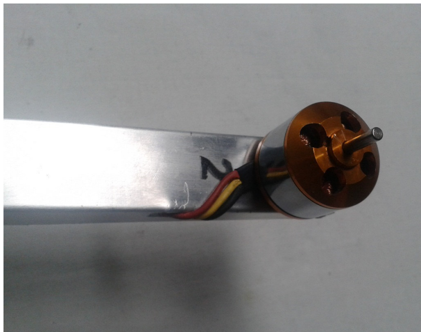
Figura 3.57: Motor Brushless asegurado al brazo 2
