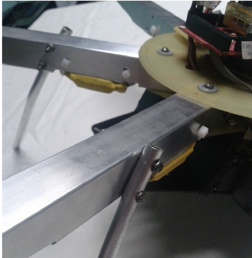
Figura 3.64: Vista de los soportes frontales
