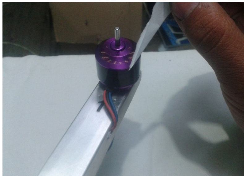
Figura 3.85: Verificación del sentido de giro
