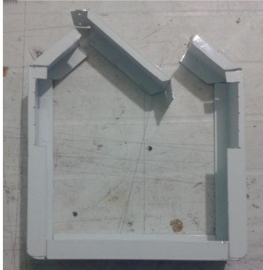
Figura 3.23: Marco del transmisor fabricado en aluminio
