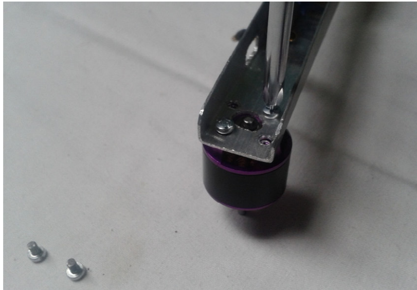
Figura 3.55: Atornillado de los motores brushless
