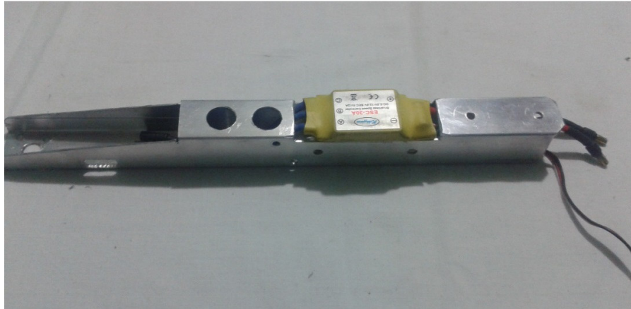
Figura 3.46: Sujeción del ESC al brazo del multicoptero Fuente: Autor
