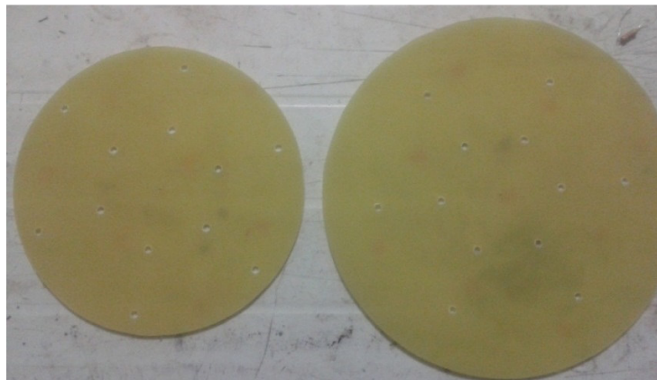
Figura 3.39: Base superior e inferior de fibra de vidrio
