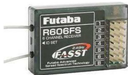
Figura: 1.18: Receptor Futaba con tecnología FHSS
