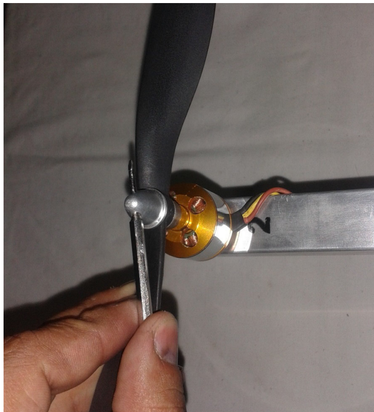
Figura 3.112: Asegurado de hélice 2
