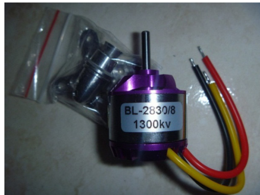
Figura: 1.15: Motor brushless de 1300 Kv
