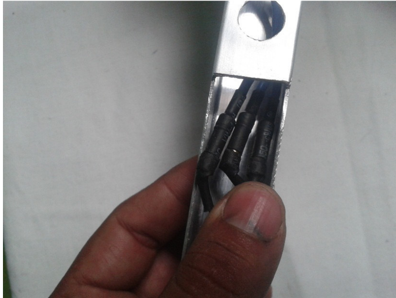
Figura 3.86: Invertir cables de conexión del ESC y motor
