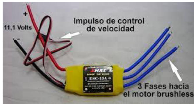
Figura: 1.16: Controlador Electrónico de velocidad
