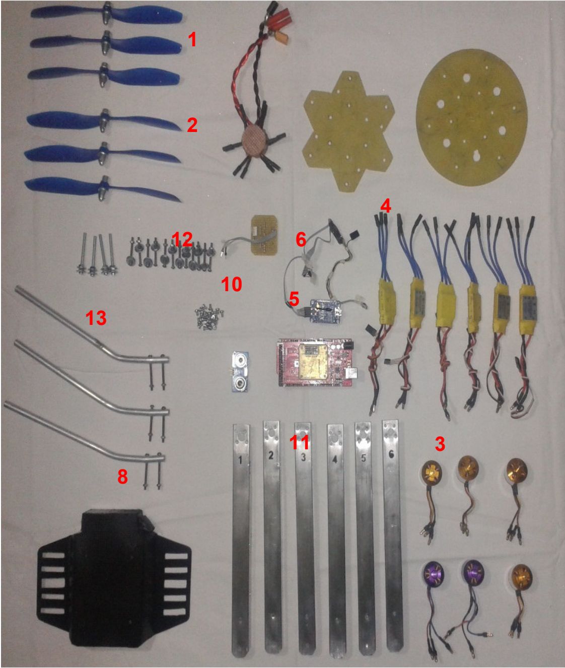
Figura 3.41: Vista panorámica de los componentes del hexacóptero
