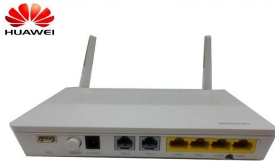
Figura 41. ONT Huawei modelo HG8245H
