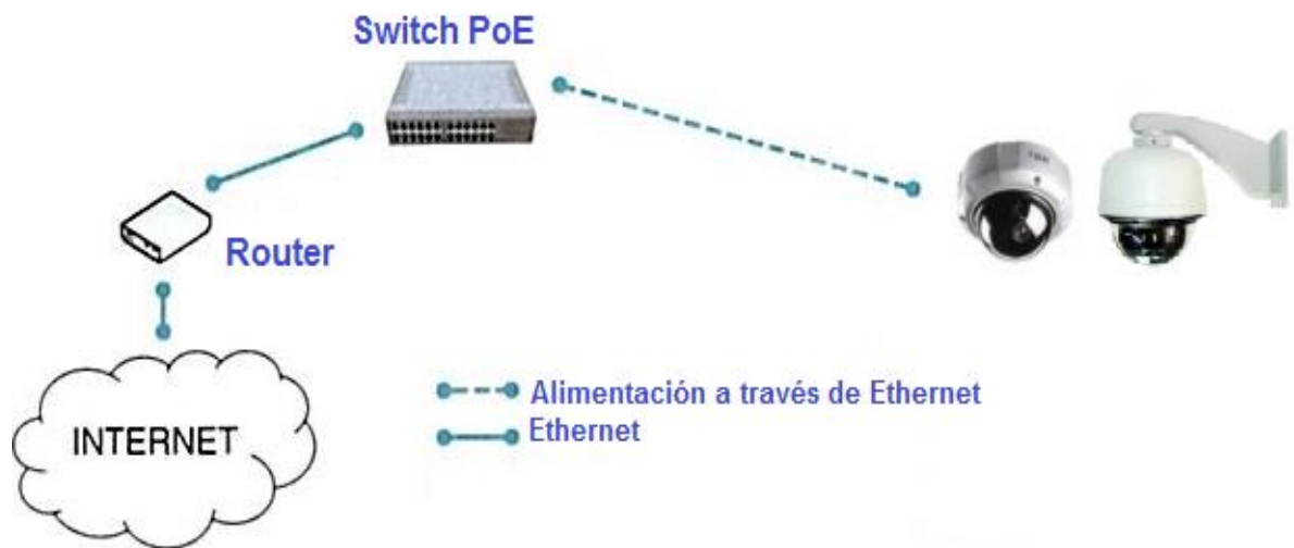
Figura 15. Conexión del sistema de video vigilancia
