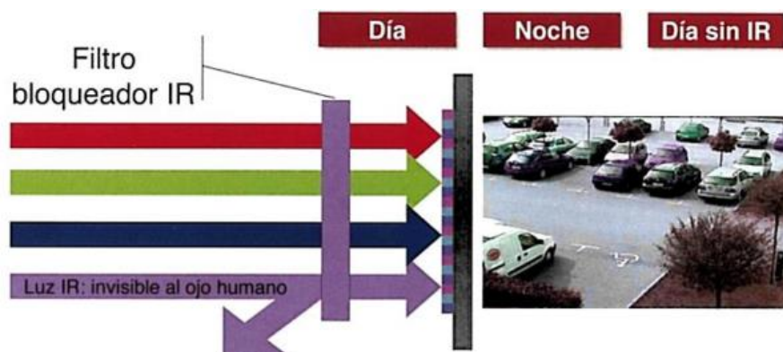
Figura 7. Filtro IR de una cámara
