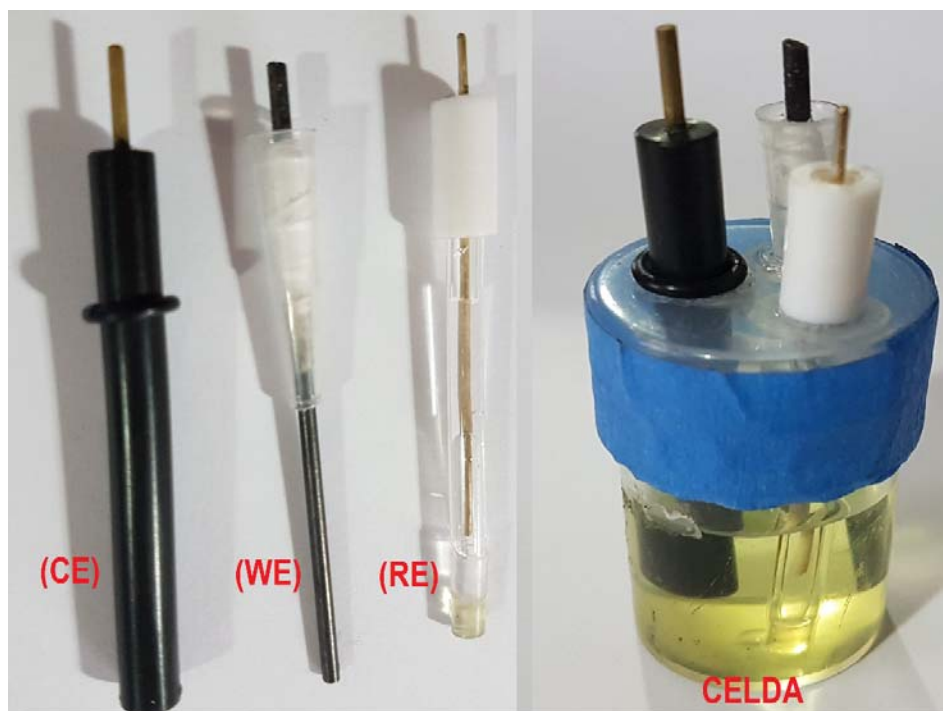
Figura: 3 Electrodos usados en la celda.
