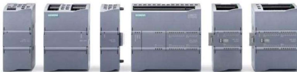
Figura 41 Arquitectura del PLC SIMATIC S7 1200.
