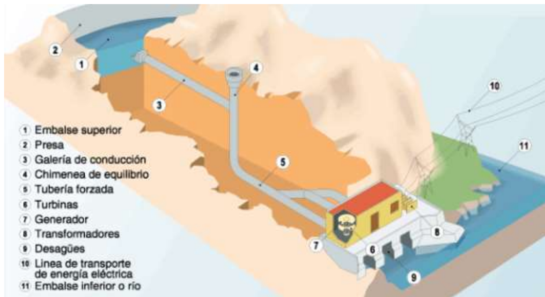
Figura 6 Esquema de una central de bombeo puro o reversible
