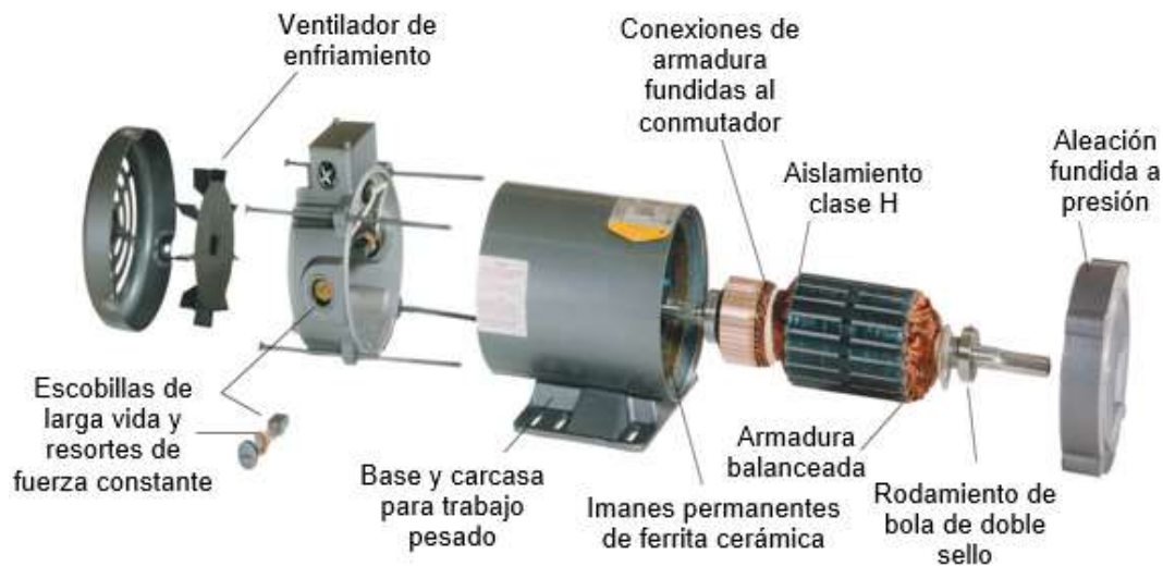
Figura 17 Motor/Generador DC de imanes permanentes
