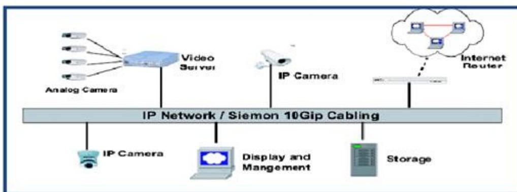
**Figura 2. Diagrama de video digital sobre IP**
