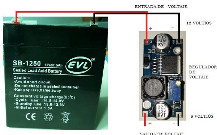
Figura 81. Conexión batería y regulador de voltaje
