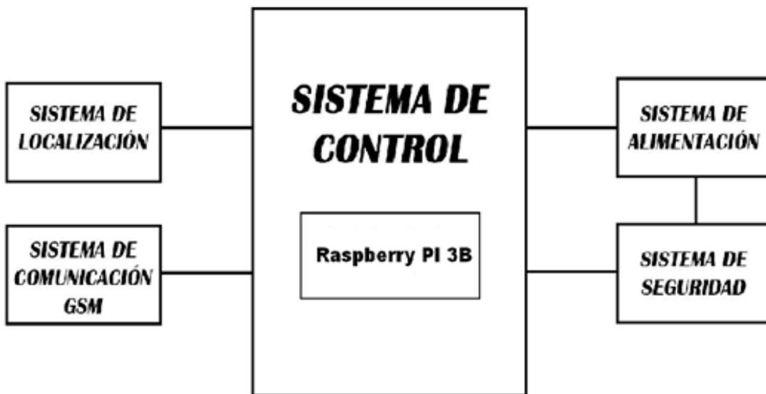
Figura 28. Diagrama de bloques del sistema de control
