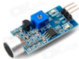
**Vcc, GND y OUT.** Vcc es el pin que se debe de conectar a la fuente de tensión (5V), GND es la toma a tierra y por último OUT es el pin de salida al que va a conectar el sensor (en este caso se ha conectado a **A0**). Cabe destacar que este sensor recoge datos analógicos, por lo que debe de conectarse a los pines hembra de la parte analógica, no en la digital (cosa fácilmente confundible, pues se puede pensar que simplemente recoge sonido (1) o no recoge sonido (0), pero no es así).
