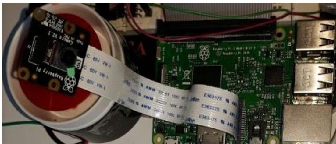
**Figura 72. Conexión cámara a la Raspberry Pi 3B**
