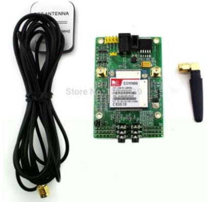
**Figura 11. Aspecto físico del SIM908 GSM/GPRS Shield**
