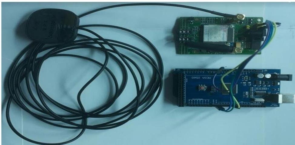
**Figura 39. Esquema de conexión del módulo GPRS al Arduino Mega 2560.**
