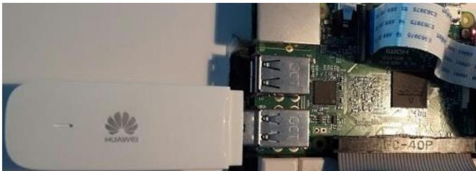
**Figura 76. Conexión USB 3G a la Raspberry Pi 3B**
