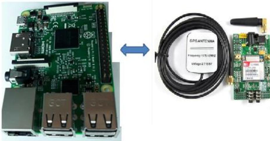
**Figura 77. Módulo GPRS Sim 908 y Raspberry Pi 3B**
