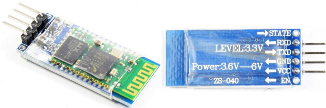
Figura 25 Módulo Bluetooth HC06
