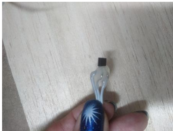
Figura 80 Instalación de sensor de temperatura analógico LM35
