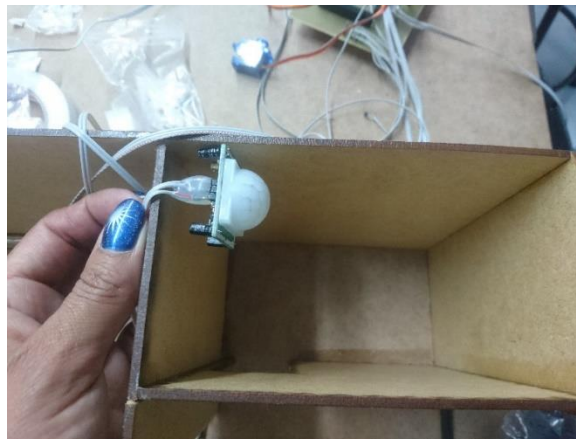
Figura 82 Instalación sensor detector de movimiento pasivo PIR
