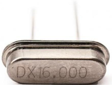
**Figura 1.6:** Cristal de cuarzo de 16 MHz.
