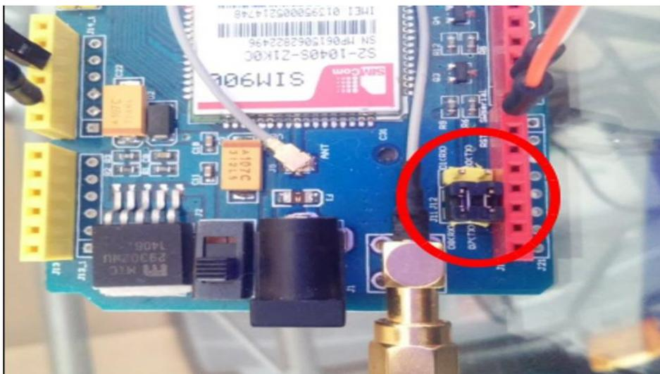
**Figura 1.4:** Conexión tarjeta SIM900.
