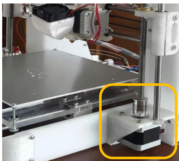
Figura 63. Instalación de motores eje X y Z
