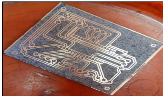
Figura. 3. 42. Impresión del diagrama en la baquelita
