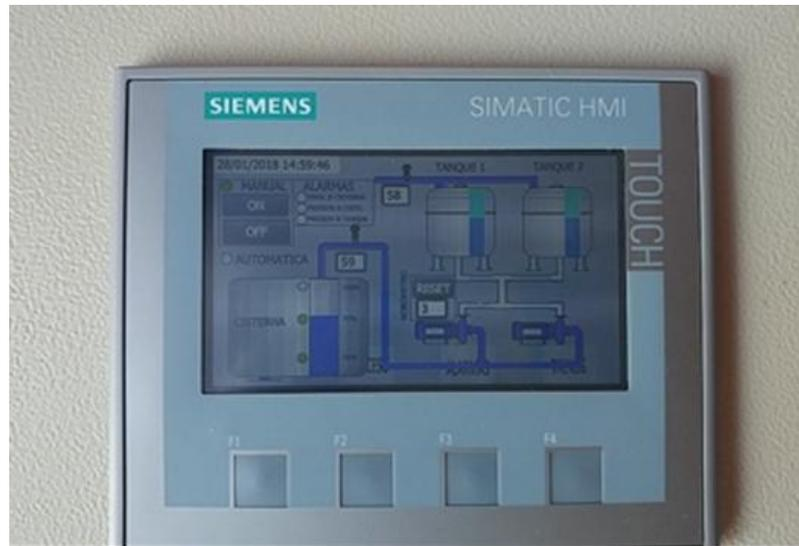
Figura 3.58. Visualización del proceso en estado de llenado completo de los tanques.
