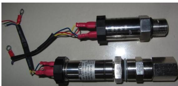
Figura 2.19. Sensor analógico de presión.
