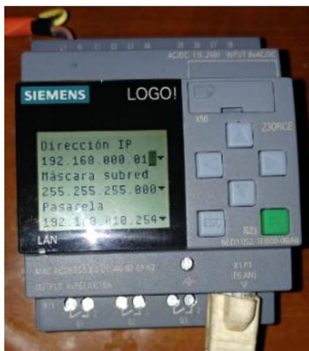
Figura 3.3. Asignación manual de dirección de IP en el PLC.
