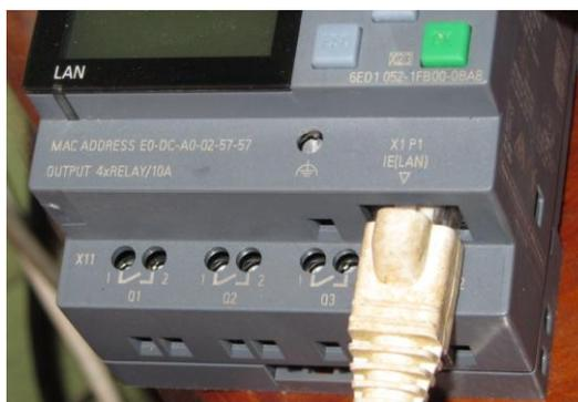
Figura 1.11. Interfaz de Comunicación Profinet.
