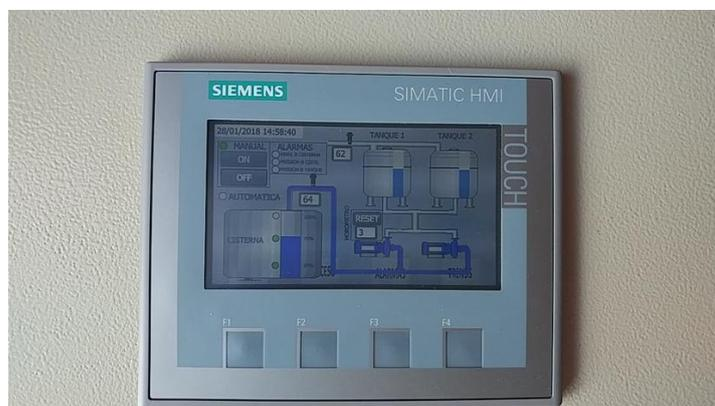
Figura 3.57 Prueba de la pantalla HMI Visualización del proceso en estado ON.
