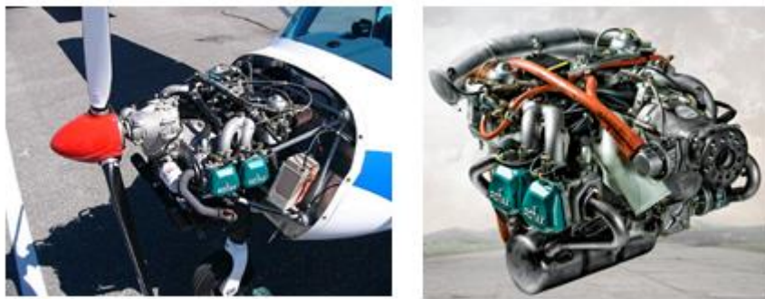
Figura 2. Avión con Rotax 912UL 100 hp (75 kW) a diésel.
