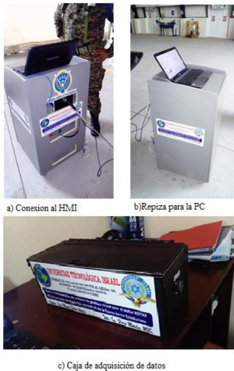
Figura 72. Banco de pruebas para el motor 912 ULS
