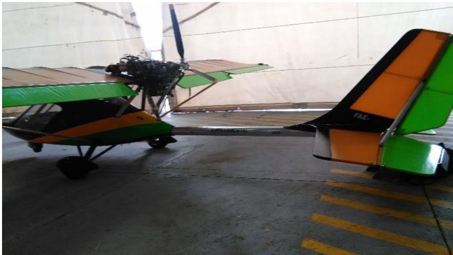
Figura 1. Avión experimental ultraligero con motor Rotax ULS 912.
