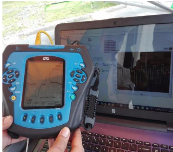
Figura 74. Lectura de señales físicas del motor ROTAX 912 ULS, medidas con el osciloscopio.
