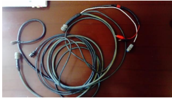
Figura 71. Arnés para adquirir las señales de los sensores, conexión en con la interfaz HMI, unión con la fuente de 12V y control ON/OFF.
