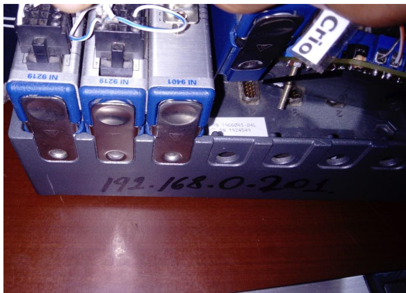
Figura 66. Colocación de los módulos NI 9401 y NI 9219
