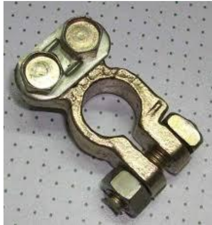
Figura. 2.5. Terminal Tipo T3
