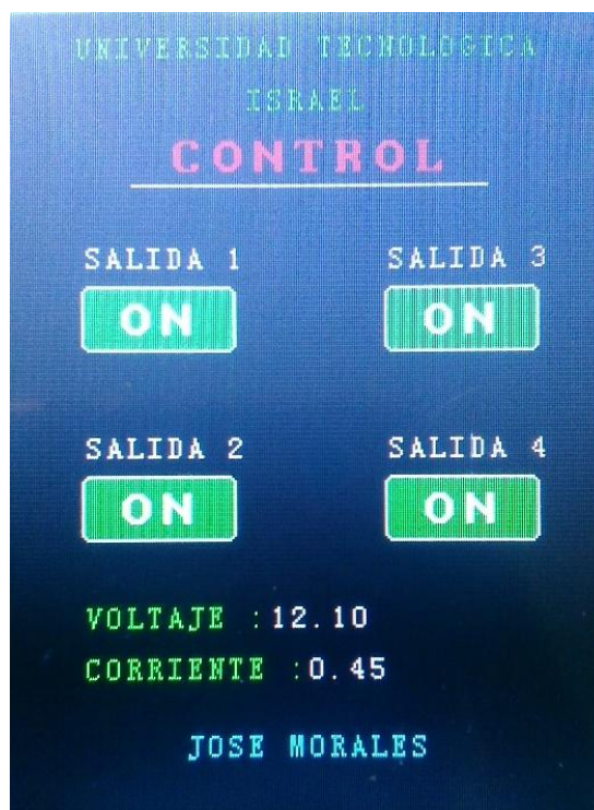
Figura. 3.13. Interface con valor de corriente y voltaje con todas las salidas desactivadas.
