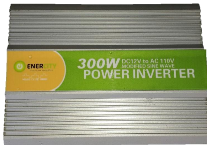
Figura. 3.7. Inversor de corriente directa a corriente alterna de 300w
