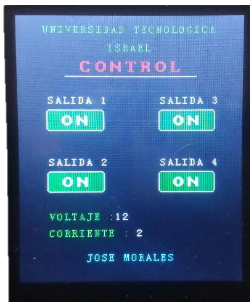
Figura. 3.3. Controlador de carga/descarga de batería, activación/desactivación de diferentes salidas.
