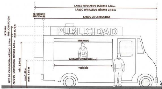
Gráfico No.11 Dimensiones permitidas para establecimientos móviles-Elevación lateral
