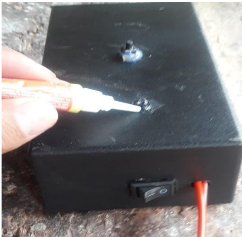
Figura 60. Sellado del led Fuente: Autor
