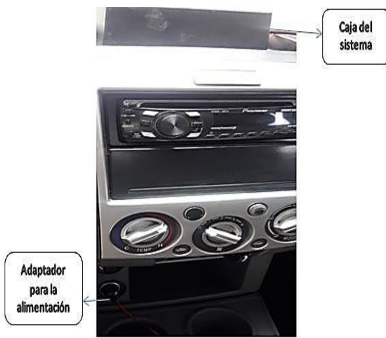
Figura 65. Ubicación del sistema en el vehículo Fuente: Autor
