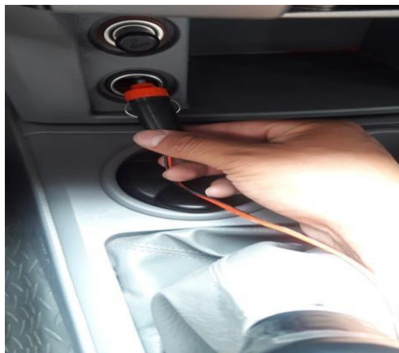
Figura 64. Instalación del adaptador en el vehículo Fuente: Autor
