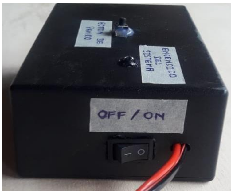
Figura 63. Señalización del botón de pánico, del switch de encendido y apagado y del led indicador Fuente: Autor
