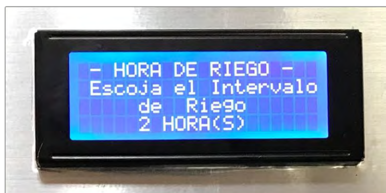
Figura 2. 31. MENU del control del intervalo de tiempo para riego.
