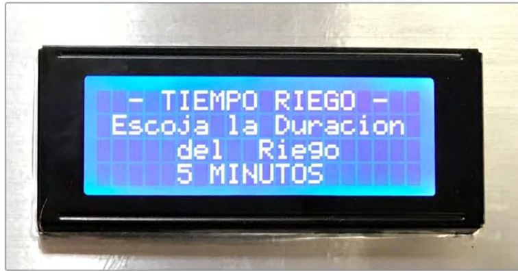
Figura 2. 29. MENU del control del tiempo de riego.
