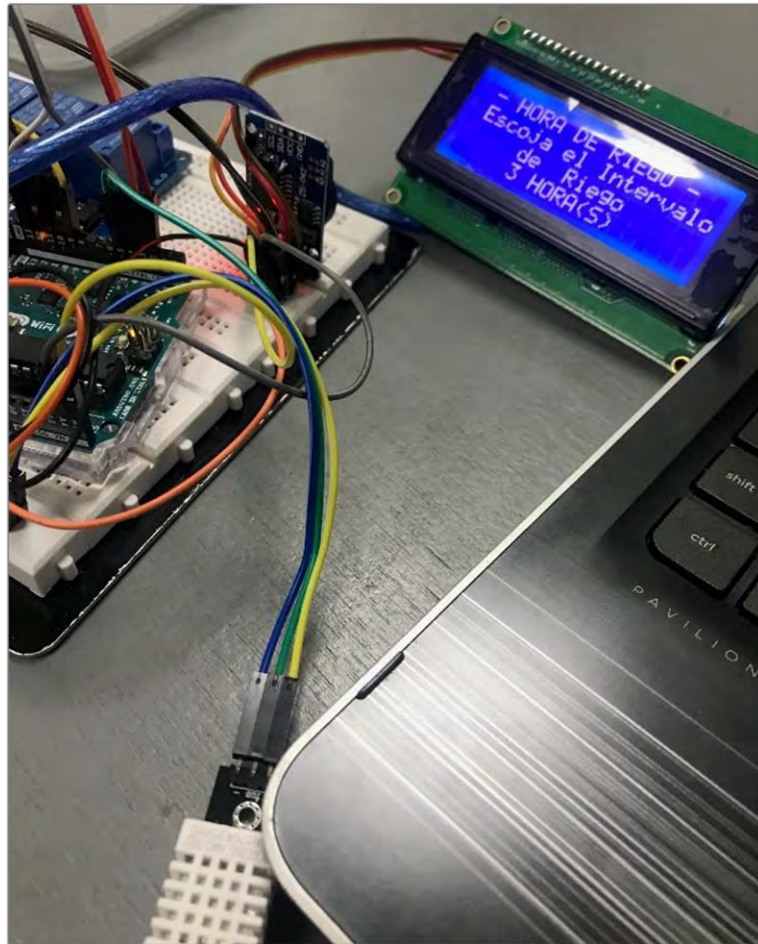
Figura 3. 33. Circuito de prueba en protoboard.
