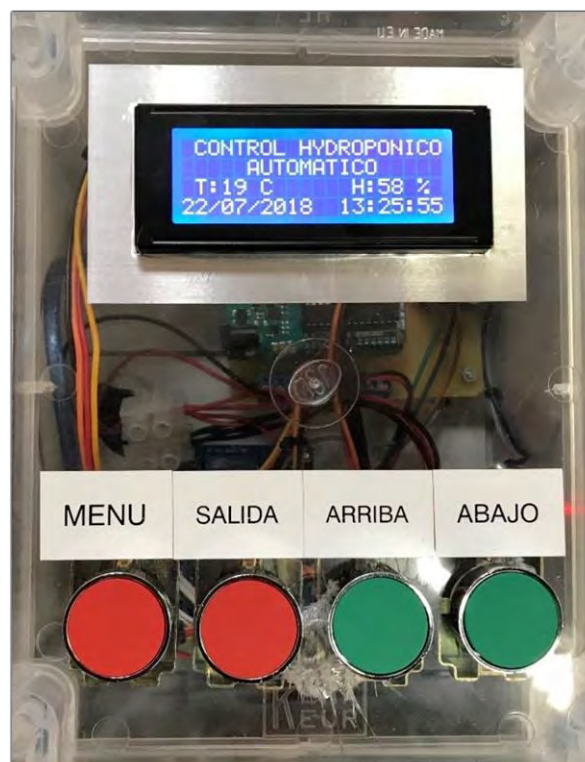
Figura 4. 42. Prueba de funcionamiento del circuito una vez ensamblado.
