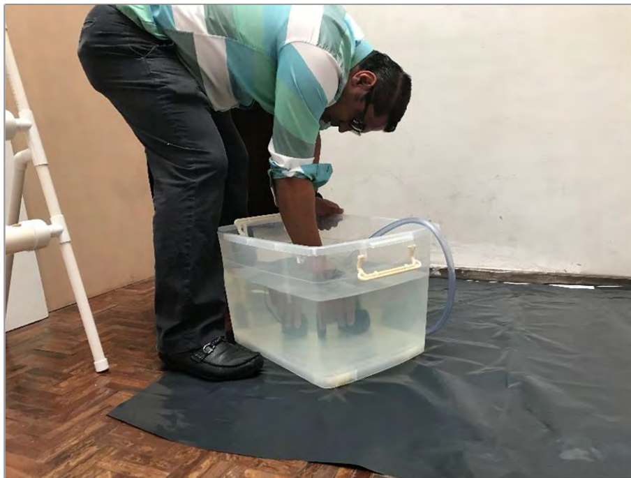
Figura 4. 46. Prueba de funcionamiento de la bomba de agua.
