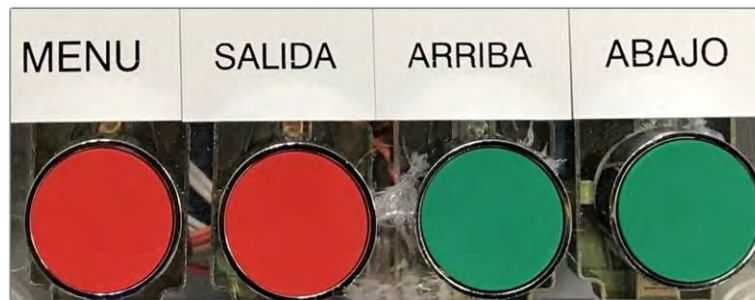
Figura 2. 16. Botones para el control Automático.
