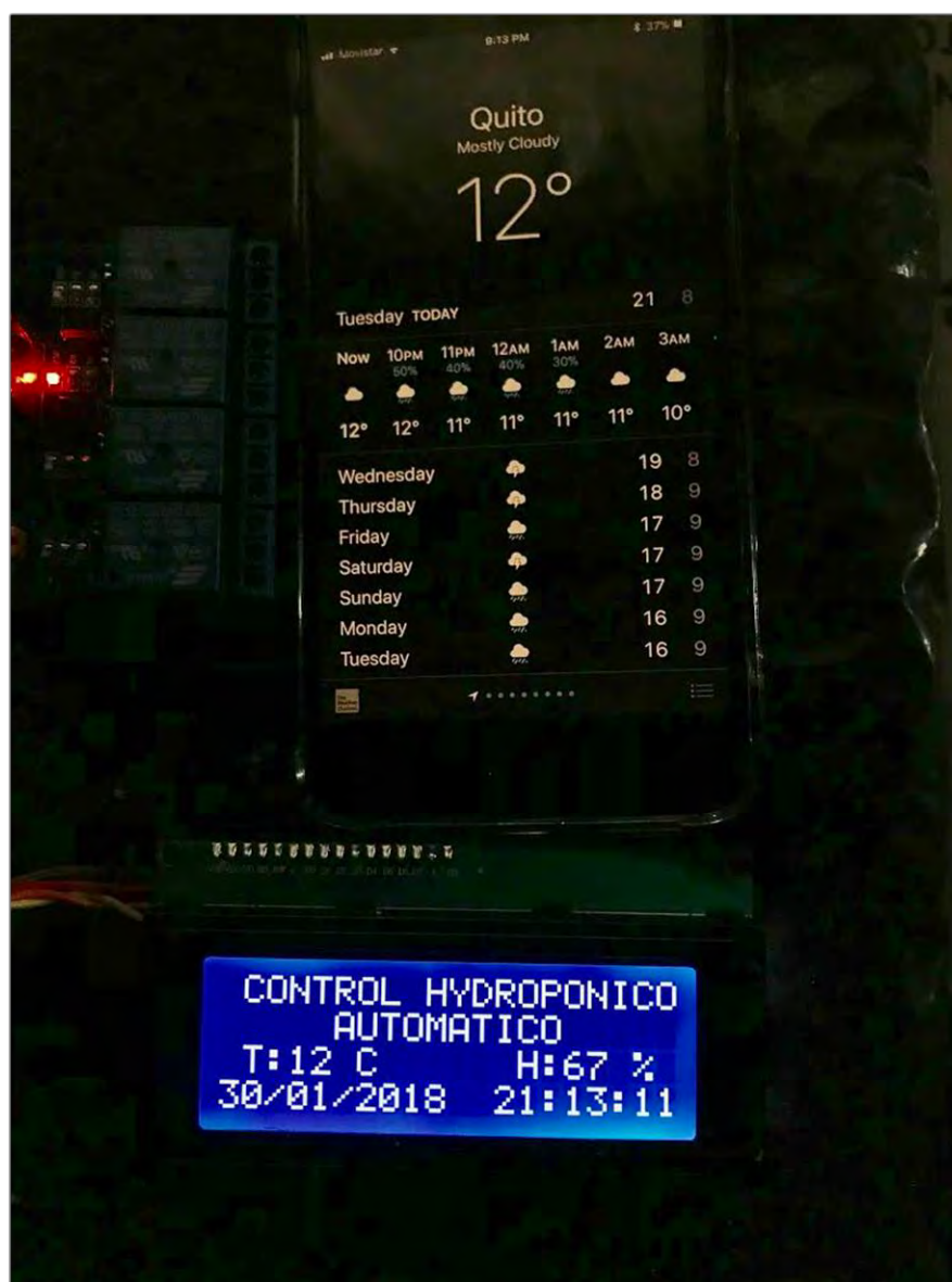
Figura 4. 43. Comparación de valores medidos por el circuito.
