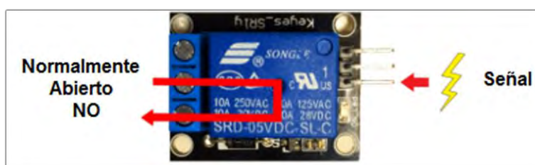
Figura 1. 11. Relé normalmente abierto (NO).
