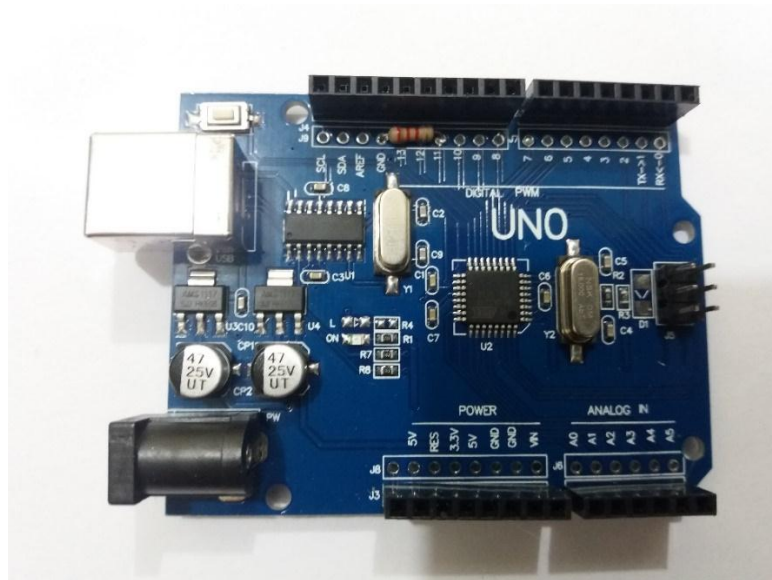
Figura 3.1 - Arduino Uno Utilizado
