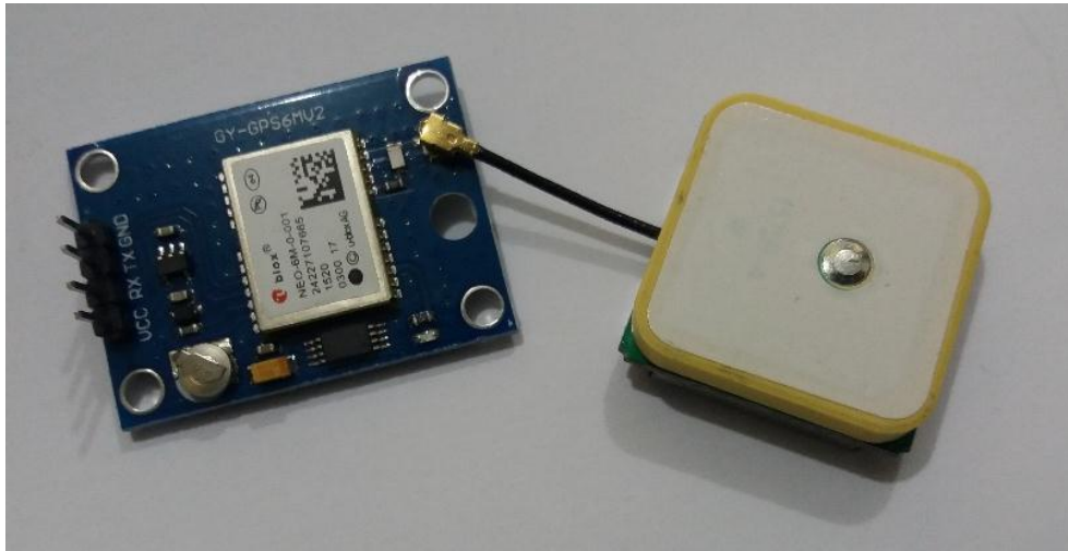
Figura 3.3 - Módulo GPS6MV2 utilizado
