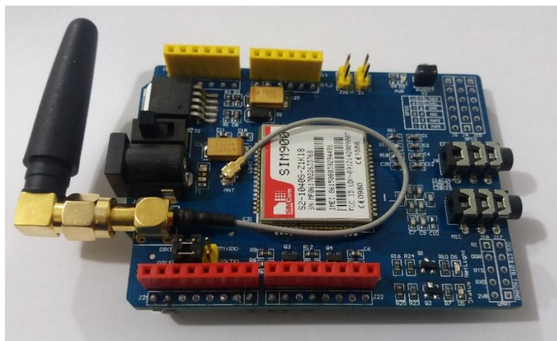
Figura 3.2 - Shield GSM – SIM900 utilizado
