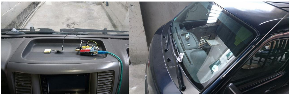
Figura 3.21 - Instalación del circuito en un vehículo
