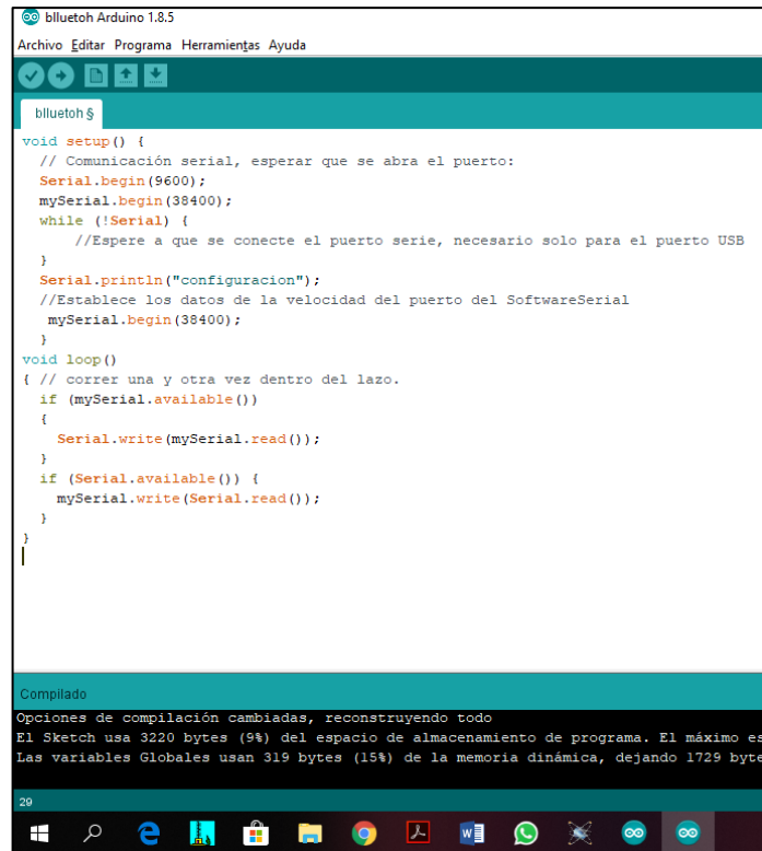
Figura. 4.7. Programa para comunicación serial con Bluetooth HC-05. [Autor]
