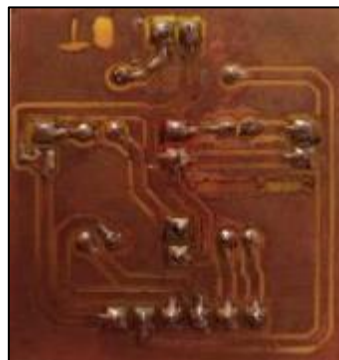
Figura. 4.20. Circuito impreso de LEDs. [Autor]
