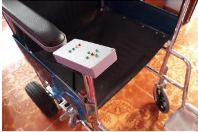
Figura. 4.29. Caja de LEDs activados por parpadeo y atención. [Autor]
