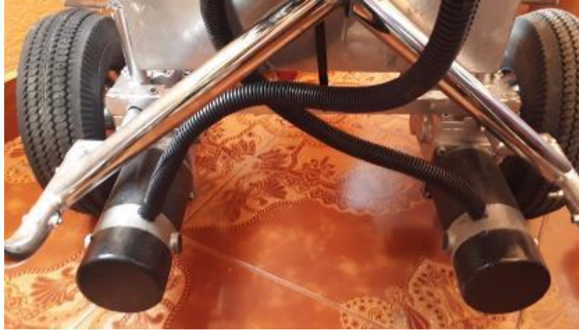
Figura. 4.4. Conexión de motores a silla de ruedas. [Autor]
