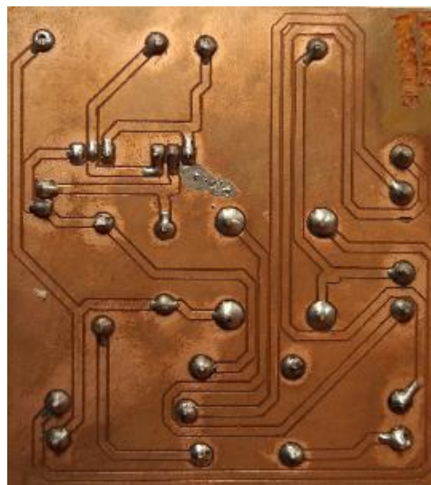
Figura. 4.22. Circuito impreso de cargador de batería de 12 voltios. [Autor]
