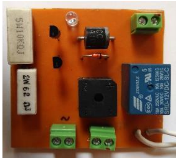
Figura. 4.25. Circuito cargador de batería de 12 voltios a 3 amperios ensamblado. [Autor]
