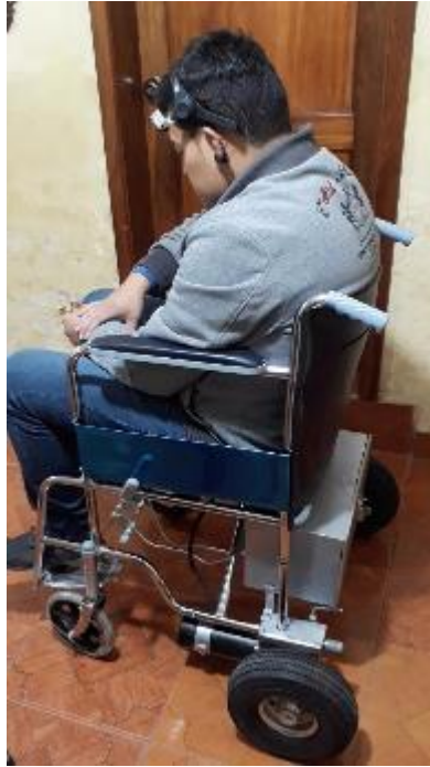
Figura. 4.27. Silla de ruedas eléctrica ensamblada. [Autor]
