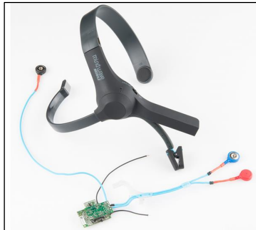
Figura. 1.24. Partes internas de Mindwave Mobile . (Kravitz, 2013)
