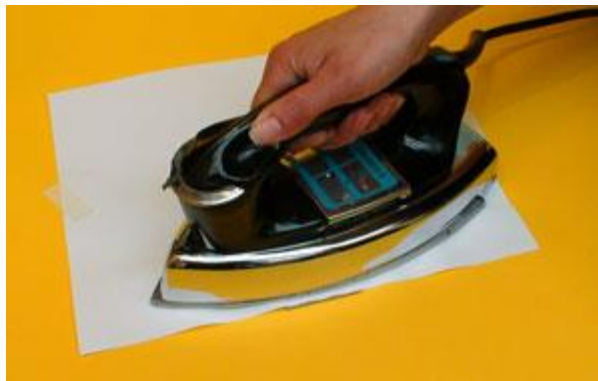
Figura 4.7 Transferencia a la placa
