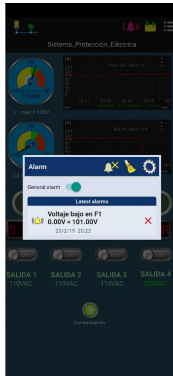
Figura. 4. 54. Alarma del sistema por apagado fase 1.
