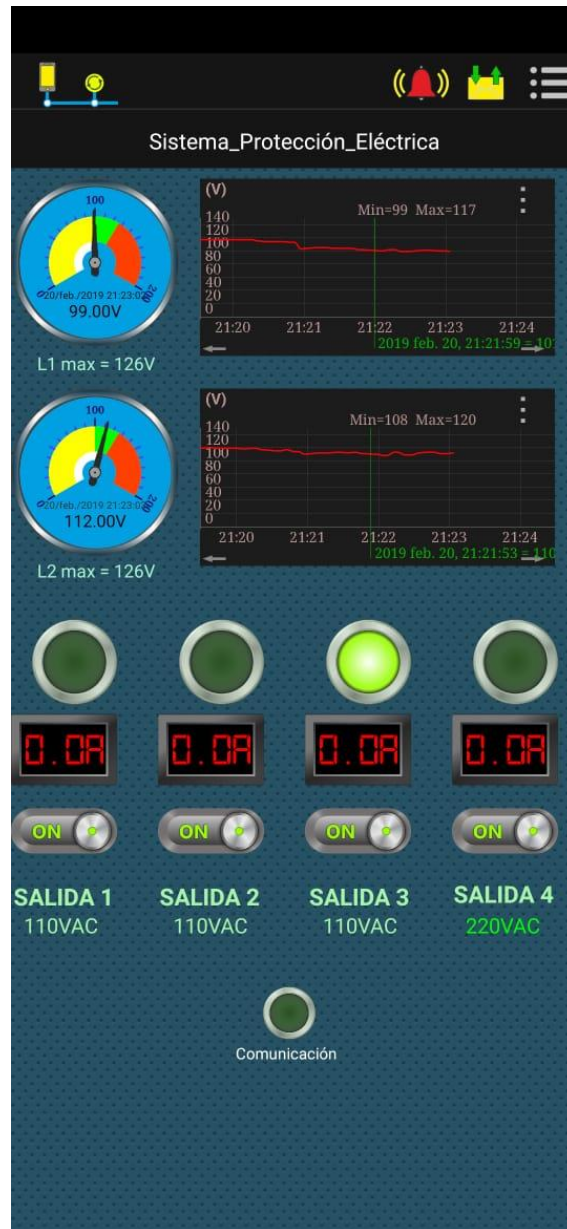
Figura. 4. 52 Voltaje en fase 1 < 100VAC.
