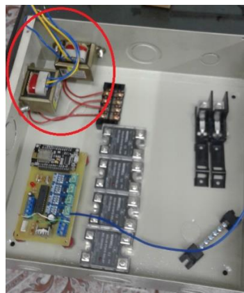
Figura. 4. 8. Transformadores ubicados en chasis.
