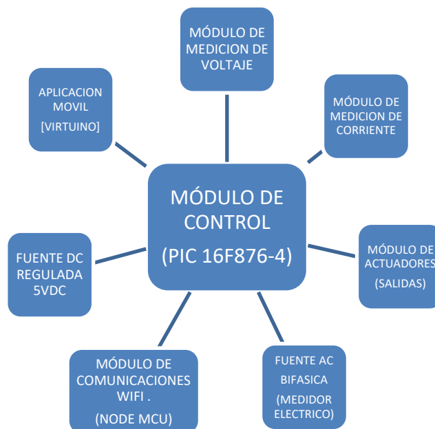
Figura. 3. 1. Diagrama de bloques sistema inteligente de protección eléctrica.
