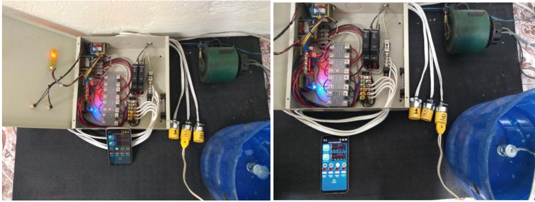
Figura. 4. 47 Banco de pruebas conexión de carga en diferentes salidas.
