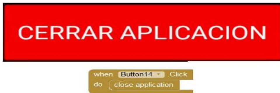
Figura. 4.41. Programación botón cerrar aplicación. Fuente: Elaborado por el Autor.
