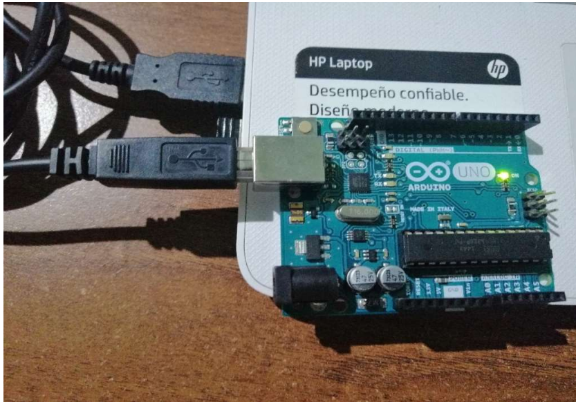
Figura. 4.46. Carga de programación al Atmega 328P. Fuente: Elaborado por el Autor.
