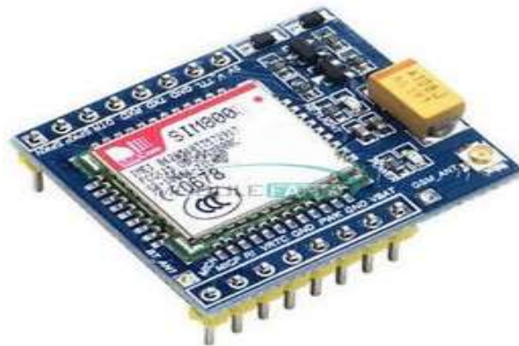
Figura. 1.21. Módulo SIM800. Fuente: (Ebay, 2019).
