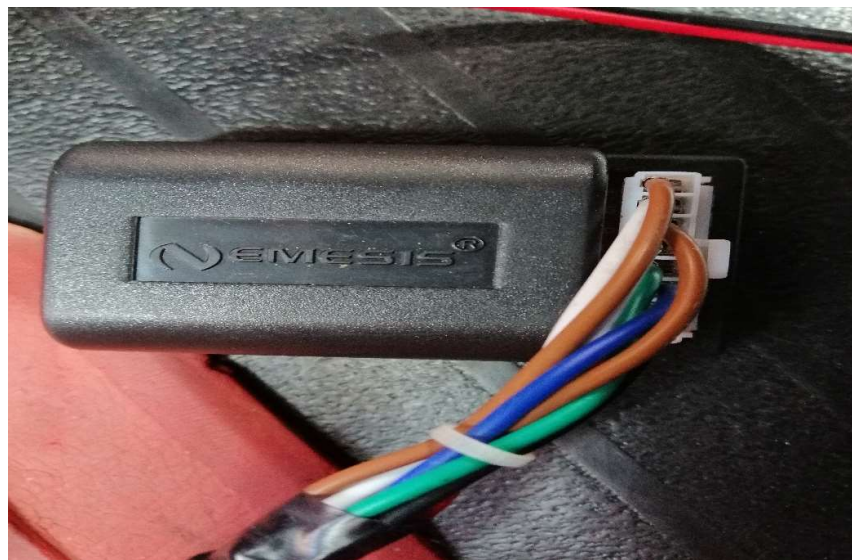
Figura. 4.60. Conexión a módulo de bloqueo central. Fuente: Elaborado por el Autor.
