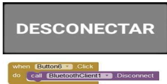
Figura. 4.40. Programación botón desconectar. Fuente: Elaborado por el Autor.
