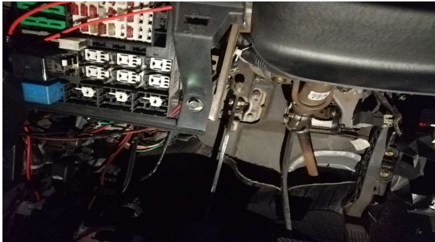
Figura. 4.61. Circuitos de bocina y ventana del conductor. Fuente: Elaborado por el Autor.
