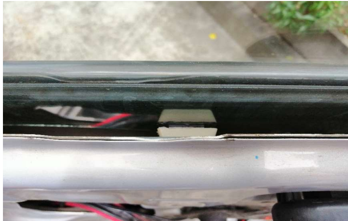
Figura. 4.59. Instalación sensor de vibración. Fuente: Elaborado por el Autor.
