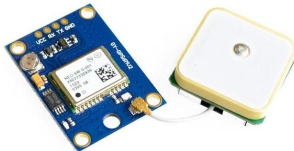
Figura 3.3 Módulo GPS (*wittronics.com.mx, 2019*)
