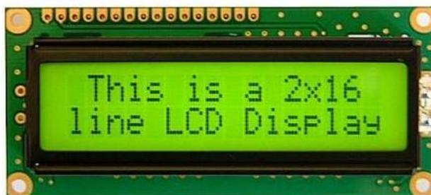
**Ilustración 4 Pantalla LCD** (*sni.cloudflaressl.com, 2018*)
