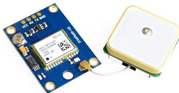
Ilustración 3 Módulo GPS (wittronics.com.mx, 2019)
