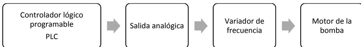
**Figura. 3. 6. Diagrama de bloques del uso de la salida analógica**
