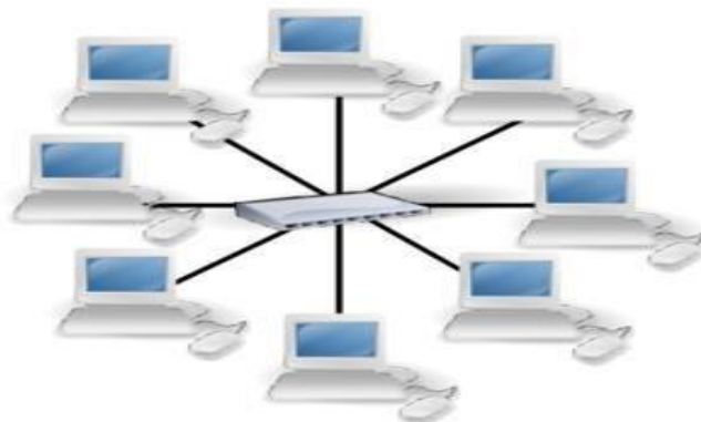
Figura 11 Diagrama de una topología estrella (Castro, 2006)
