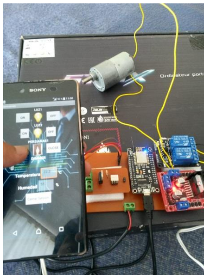
Figura. 4.18. Conexión de NodeMCU y motor para cortina
