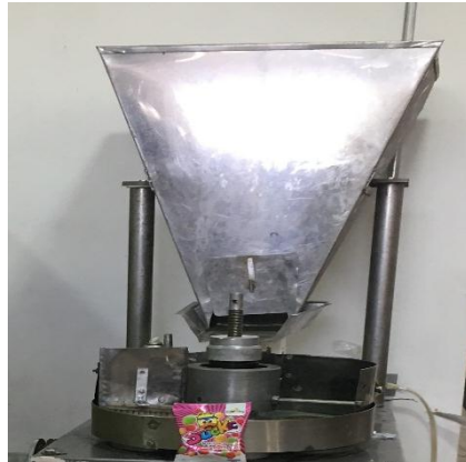
Imagen 6: Conjunto de Tolvas de Alimentacion
