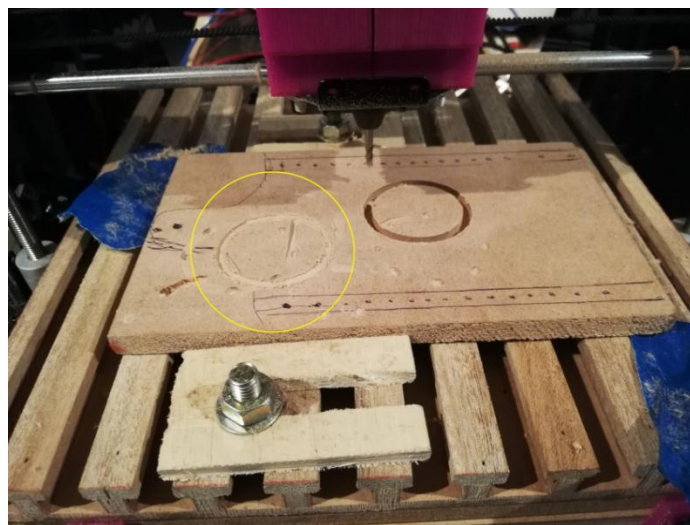
Figura. 4.62. Grabado realizado por la CNC fresadora.
