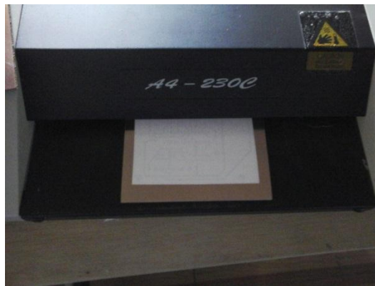
Figura. 4.21. Aplicación de calor para transferir diseño de placa.
