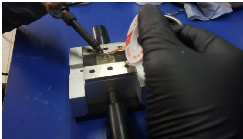
Figura 0.9 Limpieza chip BGA Fuente: Elaborado por el autor
