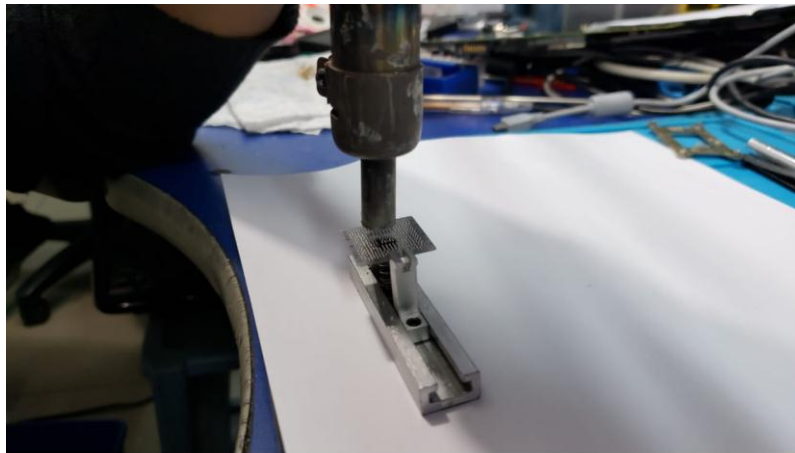
Figura 0.11 Fusión de nuevo estaño al chip BGA Fuente: Elaborado por el autor
