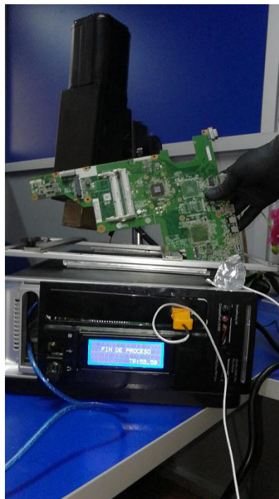
Figura 0.14 Fin del Proceso chip BGA soldado Fuente: Elaborado por el autor
