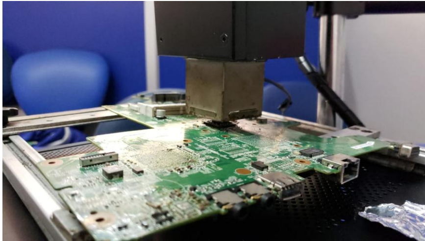
Figura 0.13 Placa y chip BGA en proceso de fusión Fuente: Elaborado por el autor
