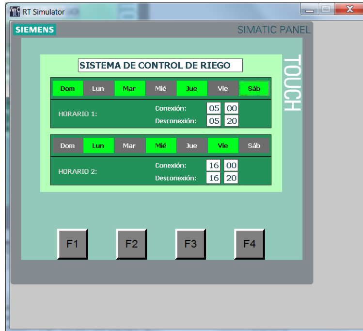
Fig. 4.14 Programación de comandos de control horario en HMI Fuente: (Elaborador por el autor)
