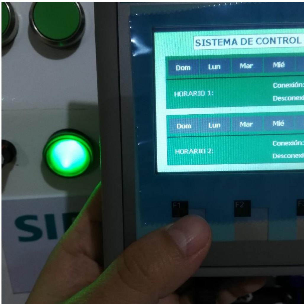
Fig. 4.25 Pruebas de funcionamiento manual de la bomba Fuente: (Elaborador por el autor)
