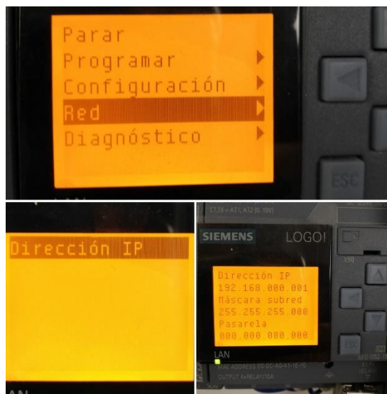
Figura 4 Pantalla de configuración de dirección IP en LOGO!
