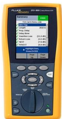
Figura. 3.13. Dispositivo Certificador de Cableado Estructurado Fuente: (FLUKE, 2017)
