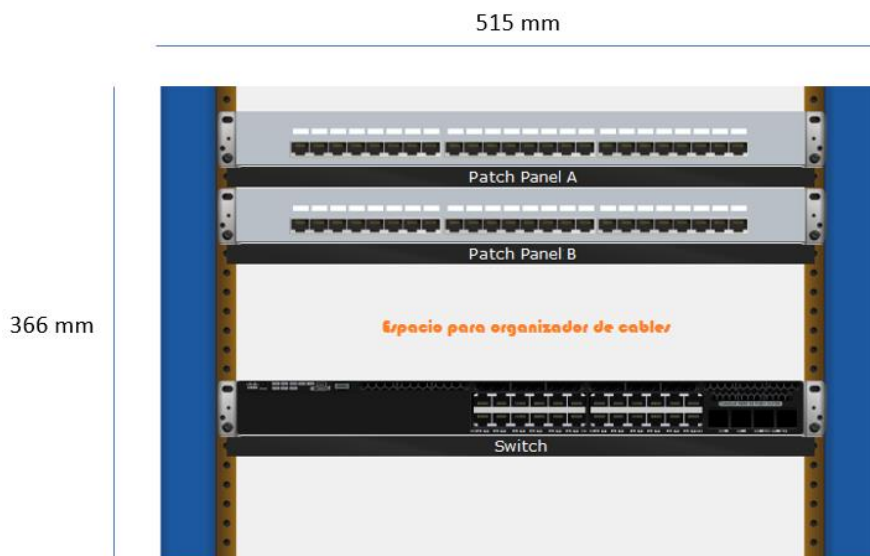
Figura. 4.4. Distribución y Dimensiones del Rack Fuente: Elaborado por el Autor
