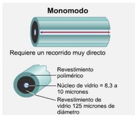
Figura 1.11. Estructura fibra monomodo
