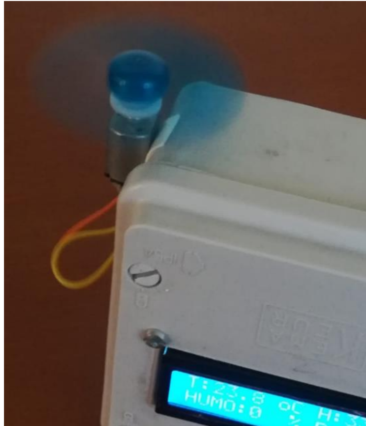
Figura 4.10: Elaborado por el autor. Accionamiento de actuador para equilibrio de humedad
