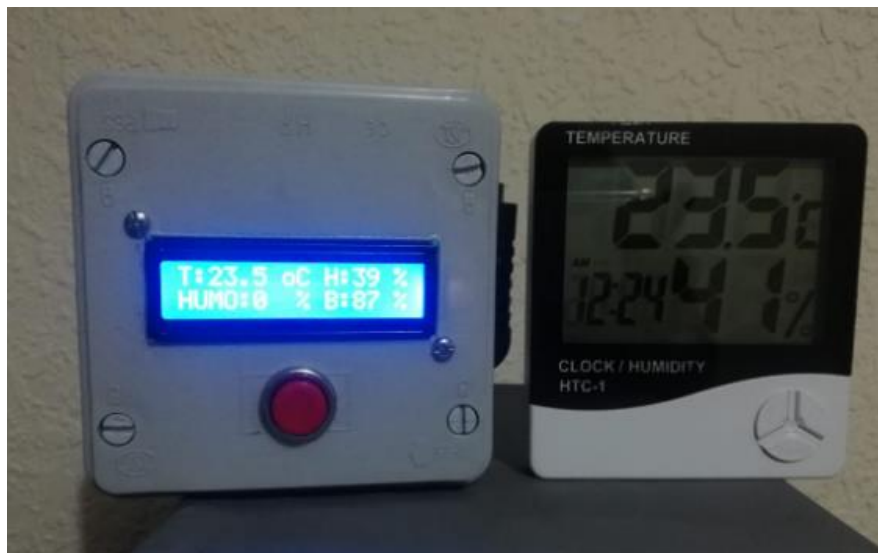
Figura 4.6: Elaborado por el autor. Visualización en pantalla LCD Zona 1 vs. Termómetro Digital
