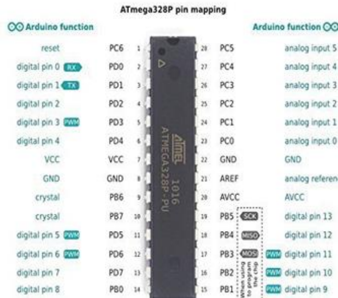
Figura 1.9: Pines del ATMEGA 328 Recuperado de: http://cort.as/-MucV
