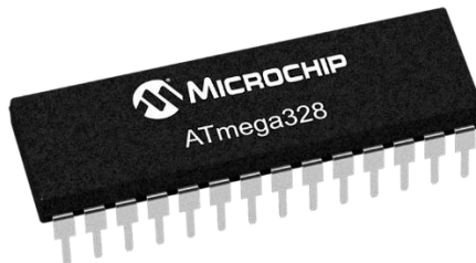
Figura 1.8: Microcontrolador ATMEGA 328 Recuperado de: http://cort.as/-MubS
