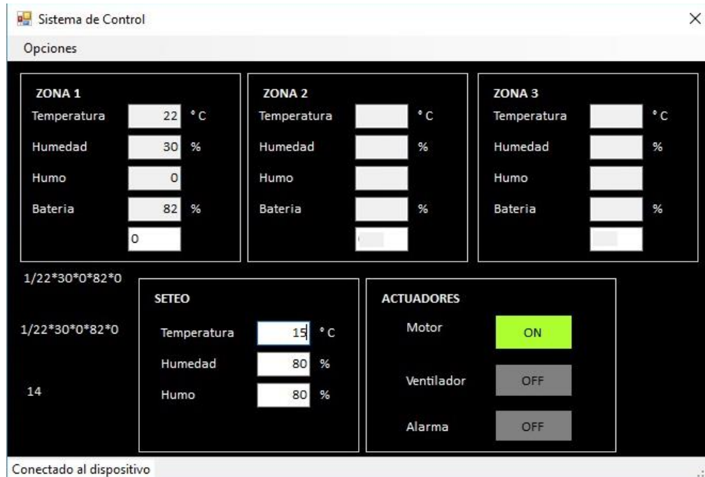
Figura 4.5: Elaborado por el autor. Visualización en pantalla HMI Zona 1
