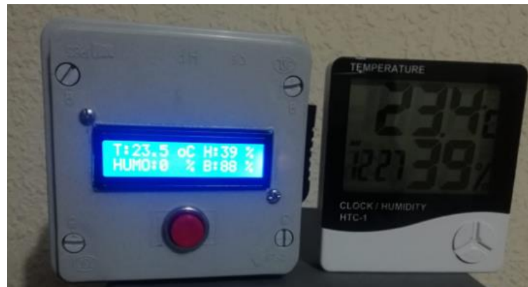
Figura 4.9: Elaborado por el autor. Visualización en pantalla LCD Zona 2 vs. Higrómetro Digital
