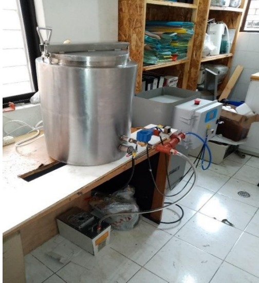
Figura 4.49. Sistema para rellenar tubos de rayos X
