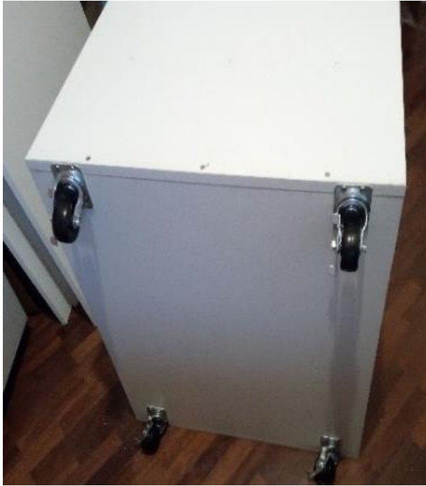
Figura. 3. 12. Instalación de las 4 ruedas para fácil traslado Fuente (Autor)
