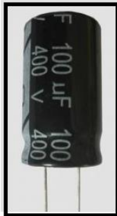
Figura. 1. 32. Ejemplo de la codificación de un capacitor electrolítico.
