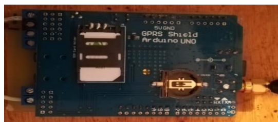
Figura. 3. 19. PCB realizada para el módulo SIM 900. Elaborado por el autor
