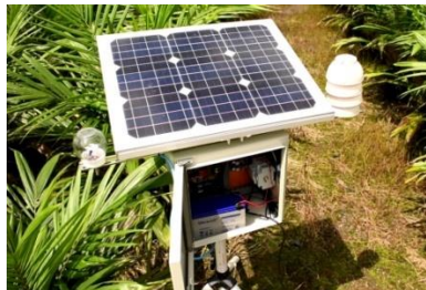
Figura. 4. 6. Estación agrometeorológica instalada en campo, fuente: Elaborado por el autor
