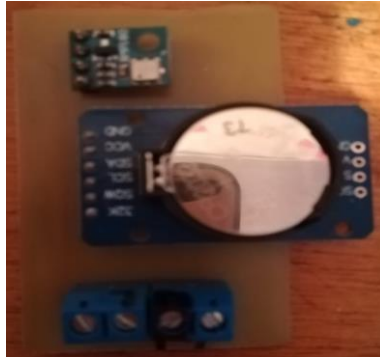
Figura. 3. 15. PCB para los dispositivos I2C RTC y BMP180, fuente: Elaborado por el autor
