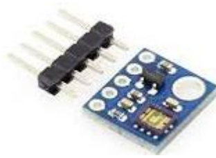
Figura. 3. 12. Sensor ML8511, Fuente: (Ddidacticaselectronicas, 2016)
