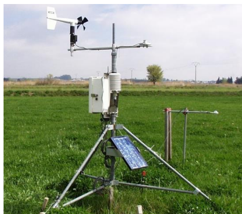
Figura. 1. 2. Partes de una estación meteorológica automática típica, fuente (Caluña & Jordán, 2017)
