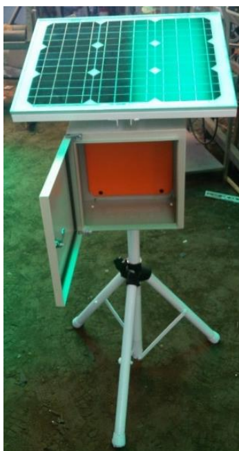
Figura. 3. 8. Ensamble final de la estructura metálica de la estación agrometeorológica,
