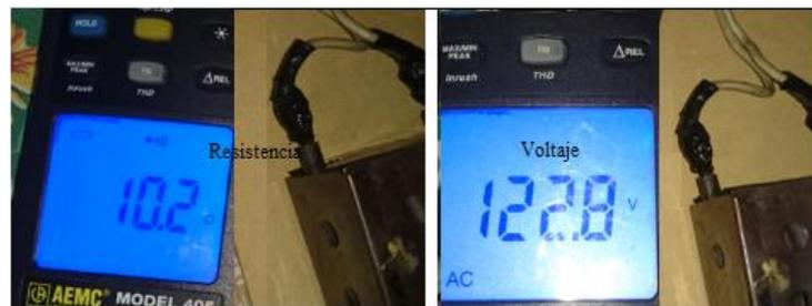
**Figura. 4.11.** Voltaje y resistencia de la niquelina
