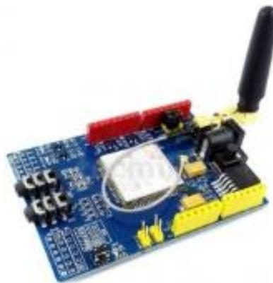
**Figura. 3.16.** Módulo GSM SIM900
