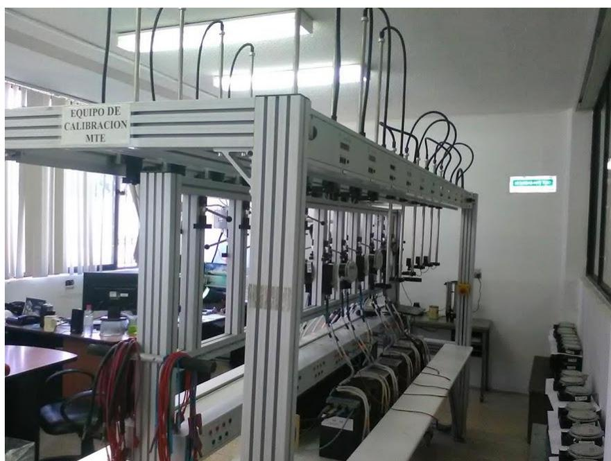
**Figura. A.3.2.** Equipo de calibración MTE, vista de perfil
