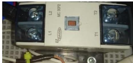
**Figura. 3.19.** Contactor para el corte y reconexión
