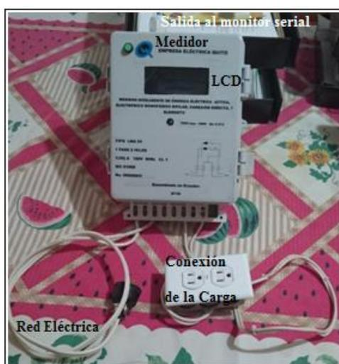
Figura. A.4.1. Medidor inteligente
