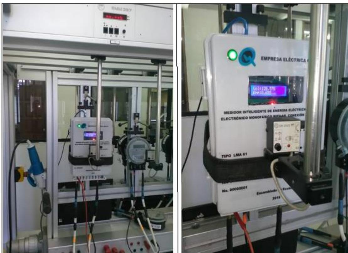
Figura. A.3.4. Medidor inteligente en equipo de calibración MTE
