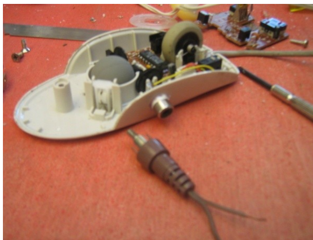
Ilustración 30 MOUSE CON CONECTOR RCA
