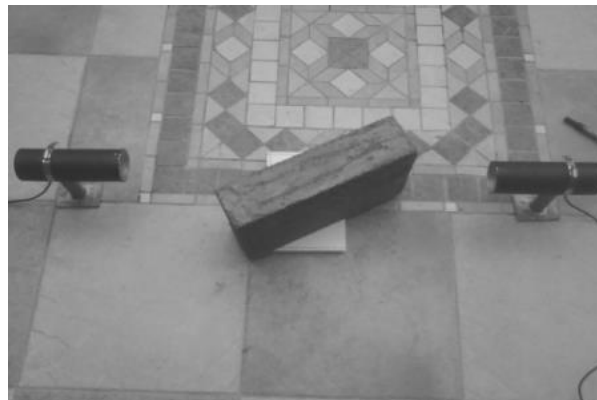
Figura 17. Montaje experimental con ángulo de incidencia de 30^\circ .
