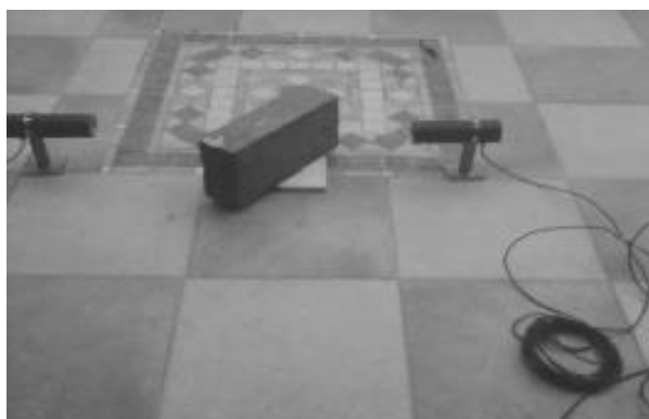
Figura 18. Montaje experimental con ángulo de incidencia de 60^\circ Fuente: elaboración propia (2019)
